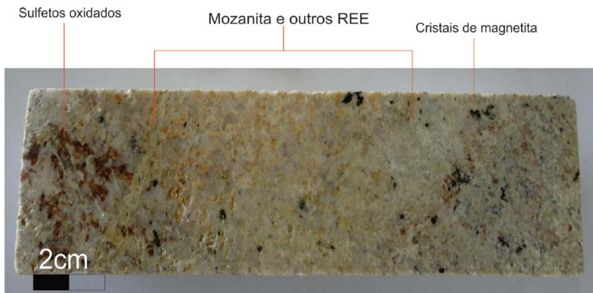
Figura 5.4 – Mg- Carbonatito apresentando monazita (porções amareladas) e sulfetos já oxidados. Rocha de coloração esbranquiçada, fanerítica fina, estrutura maciça. A mineralogia da rocha é composta por: matriz de carbonato, com magnetita, monazita, calcopirita e pirita.
