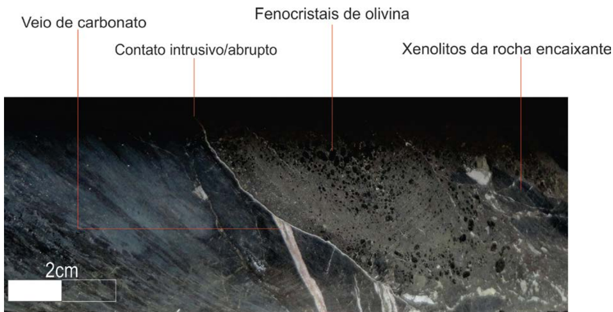
Figura 5.1 - Amostra de testemunho de sondagem de um filito. O contato abrupto entre o dique de picrito (à direita) de coloração verde com fenocristais de olivina arredondados e xenólitos da rocha encaixante. Observa-se também que um dique de carbonatito de espessura milimétrica anterior ao dique picritico é cortado pelo mesmo. À esquerda encontra-se a rocha encaixante do complexo o Filito/Fenito.
