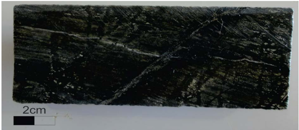
Figura 5.16 – Amostra de testemunho de sondagem de um filito. Descrição: rocha afanítica, de coloração verde, com estrutura maciça, ocorre bandas verde mais clara e escura, e não tem magnetismo. Presença de vários veios milimétricos de carbonatito, nos quais o contato entre apresenta uma mudança mineralógica caracterizando processo de fenitização.
