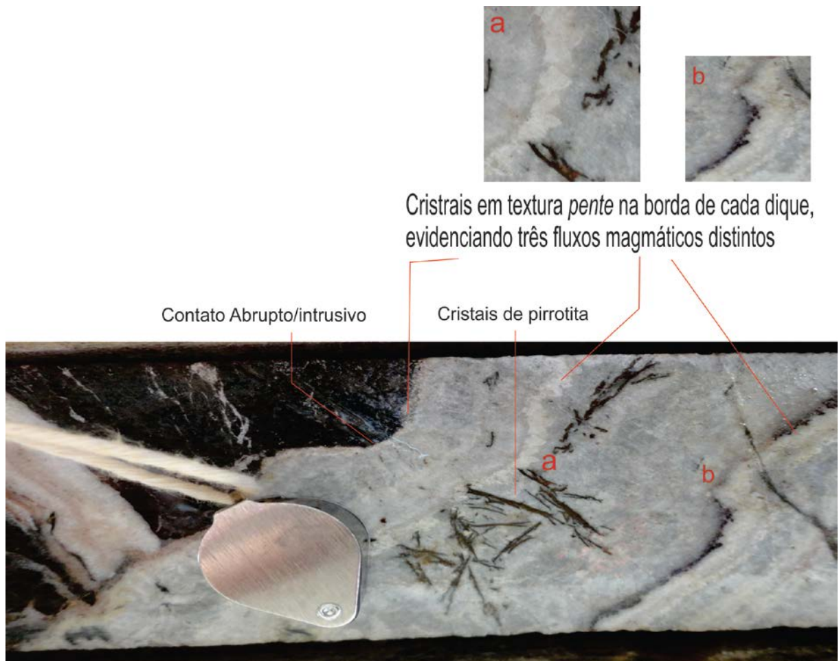
Figura 5.7 – Dique de Ca-carbonatito com ceistras alongados de pirrotita (magnéticos) indicando resfriamento rápido. Os cristais concentram-se perpendiculares a parede dos diques indicando três fluxos distintos.
