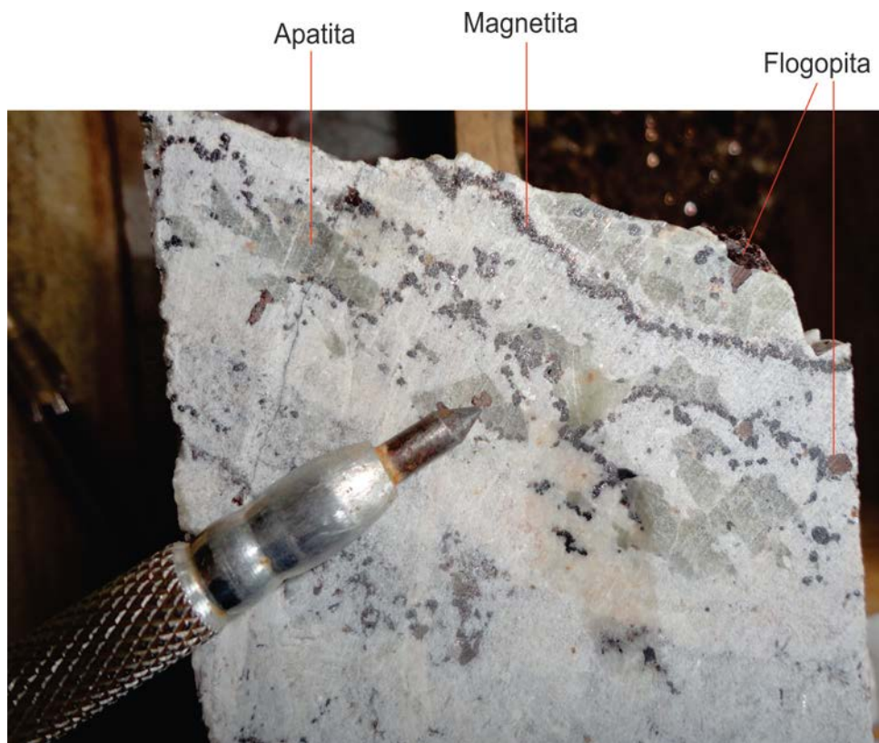
Figura 5.10 – Amostra com cristais de apatita centimétricos, flogopita e magnetita também ocorrem associados a eles, a matriz trata-se de um Ca-Carbonatito
