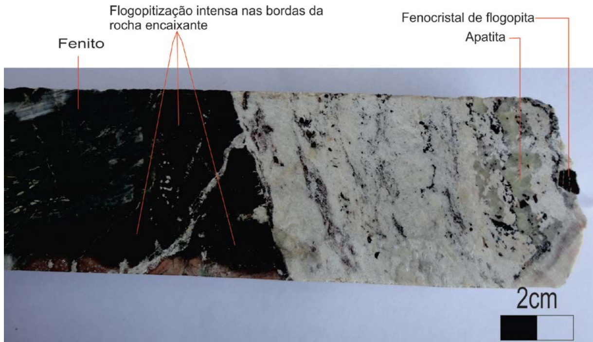
Figura 5.9 – Contato abrupto entre dique de Ca-Carbonatito e a Fenito com intensa flogopitização. A rocha ígnea possui cristais centimétricos de apatita e flogopita.
