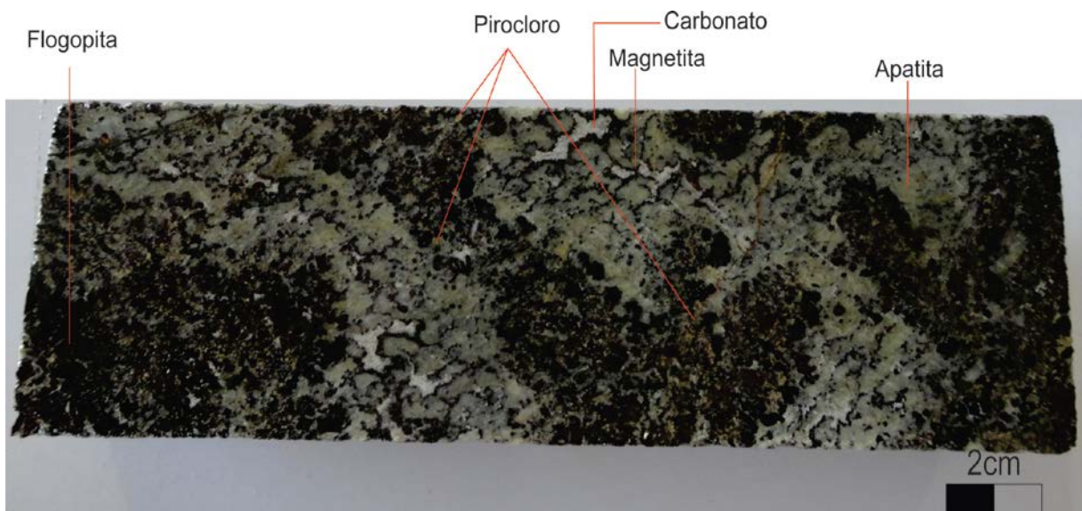
Figura 5.13- Apatita nelsonito em amostra fortemente magnética, fina a média e fanerítica. Apresenta apatite, magnetite, pirocloro, flogopita, calcopirita e carbonato.
