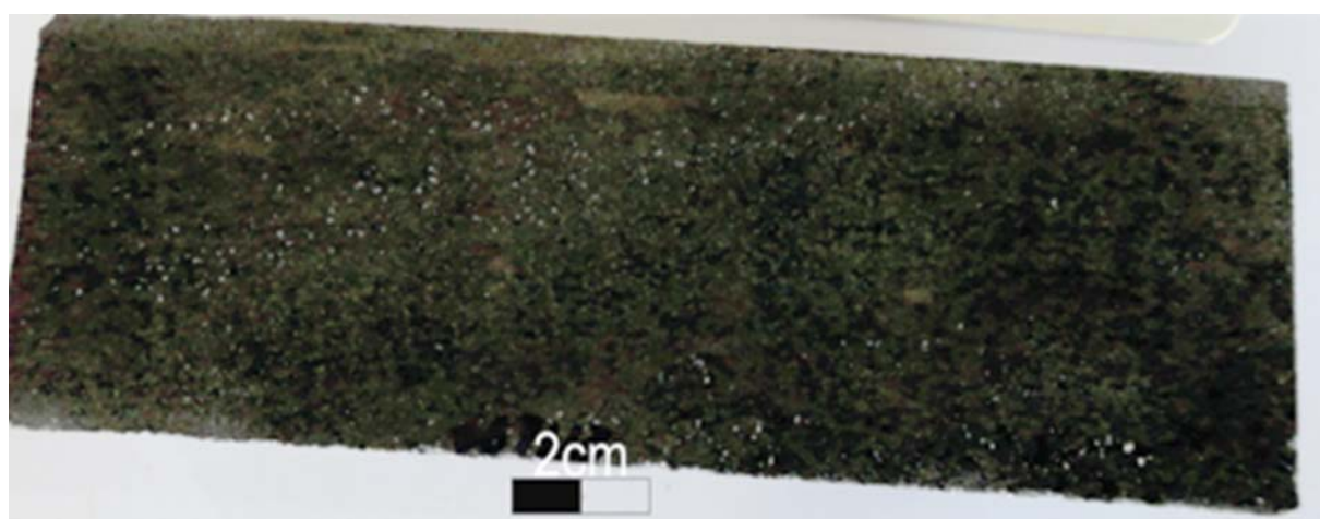
Figura 5.2 - Amostra de testemunho de sondagem de filito. Descrição: rocha de coloração verde escuro, macica, afanítica e não magnética. Apresenta glóbulos de carbonato e fenocristais de olivina que não ultrapassam 1cm.
