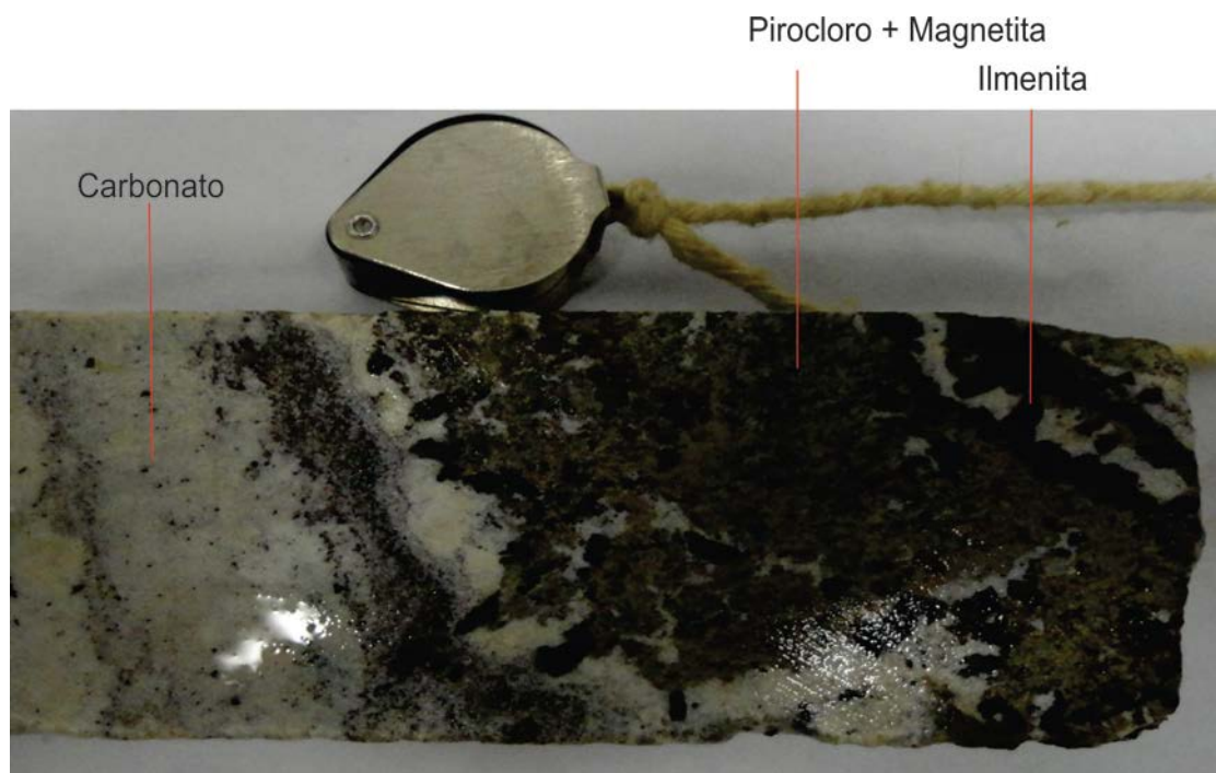
Figura 5.15 – Nelsonito rico em pirocloro. Os minerais constituintes da rocha são: magnetita, pirocloro, calcita e ilmenita.
