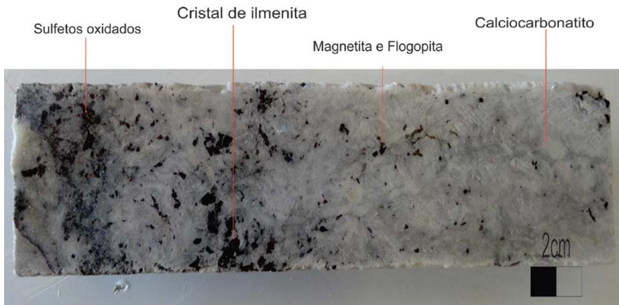
Figura 5.5 – Ca-Carbonatito com magnetita flogopita e ilmenita espalhada pela rocha e sulfetos oxidados. Rocha de coloração esbranquiçada, fanerítica fina a média, estrutura maciça. Rocha pouca magnética e textura inequigranular. matriz de ca-carbonato, com presença de flogopita 10%, magnetita 5%, ilmenita 5%, calcopirita 3%. Cristais de ilmenita centimétricos, prismáticos e eudrais.
