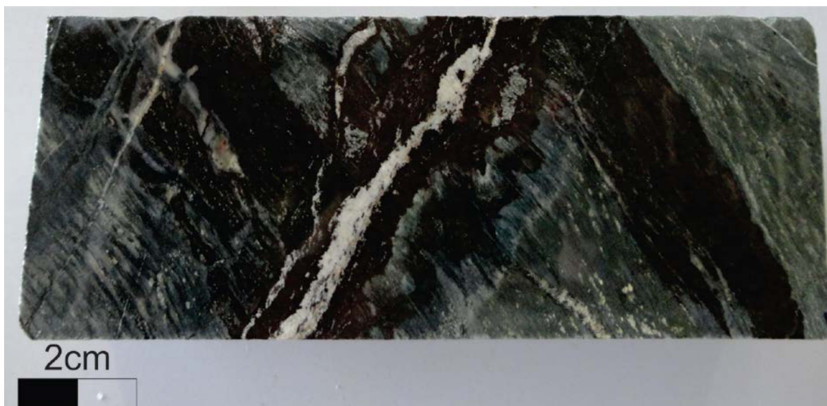
Figura 5.18 - Amostra de testemunho de sondagem de um filito. Descrição: rocha de coloração verde, bandada, afanítica, com estrutura maciça e não magnética. Um veio de carbonatito com espessura milimétrica corta a seção, sendo seus contados flogopitizados (metassomatismo alcalino o qual gera flogopita).
