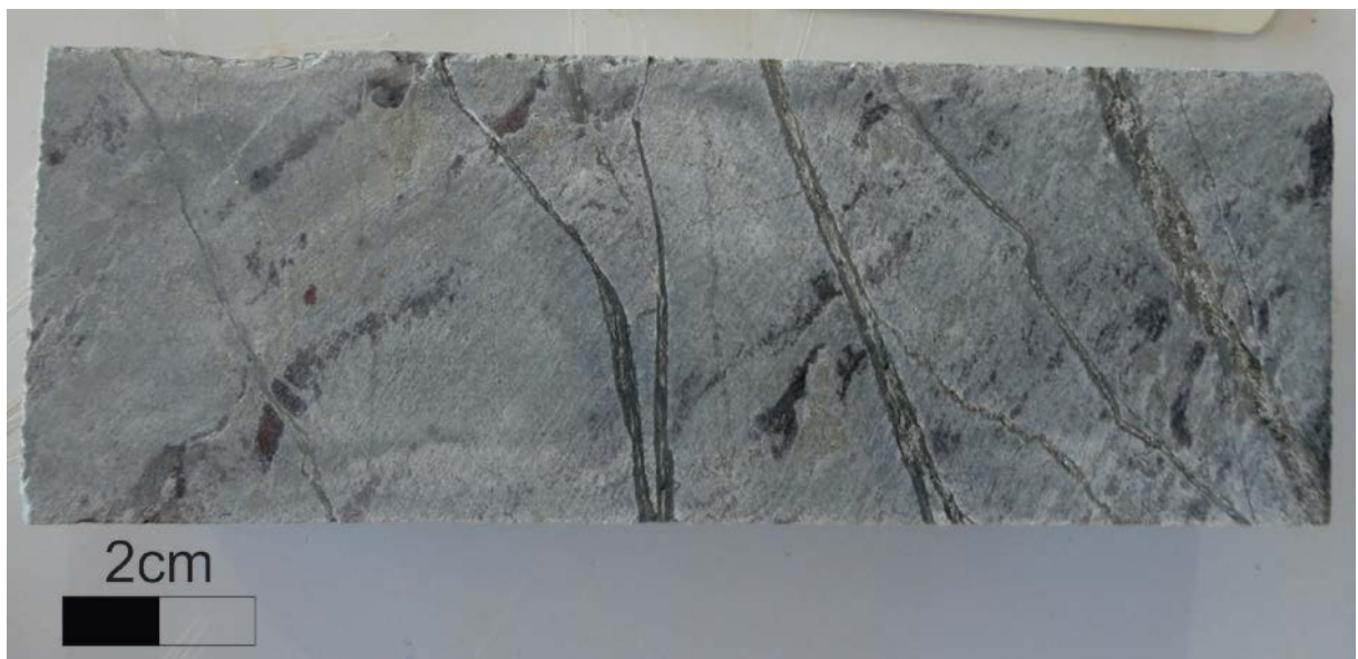
Figura 5.17 - Amostra de testemunho de sondagem de um filito. Descrição: rocha de coloração verde clara, bandado, afanítica e não magnética. Veios de espessura milimétrica de carbonatito cortam transversalmente o filito, e seus contatos estão fenitizados com uma coloração mais escura.
