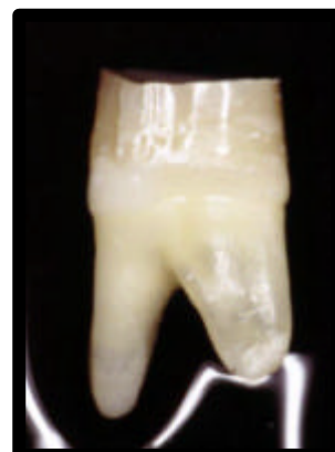
FIGURA 9 - amostra confeccionada de resina composta e estrutura dental.
