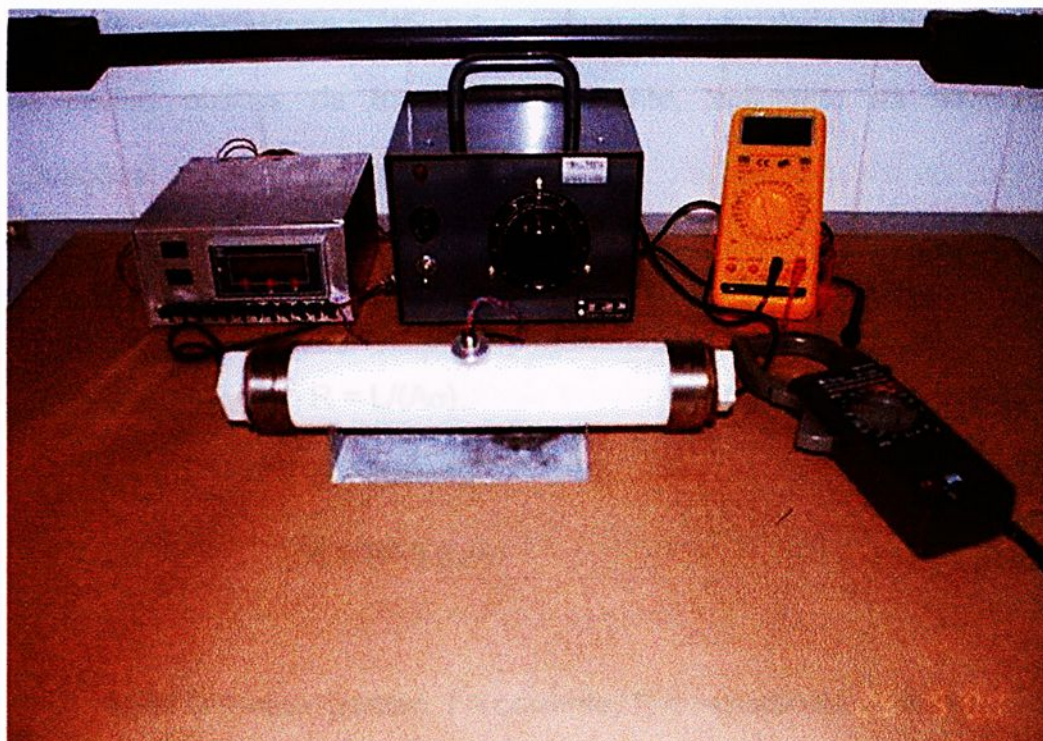
Figura 2 – Sequência montada para a medida da condutividade elétrica na célula condutivimétrica, durante o aquecimento ôhmico.
