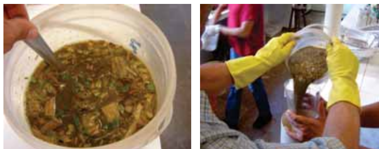
Figura 10. Abastecimento dos biodigestores com substratos utilizados no ensaio de biodigestão anaeróbia com esterco de bovinos em codigestão com cana-de-açúcar e silagem de cana nas proporções 5 e 10% de vegetal
