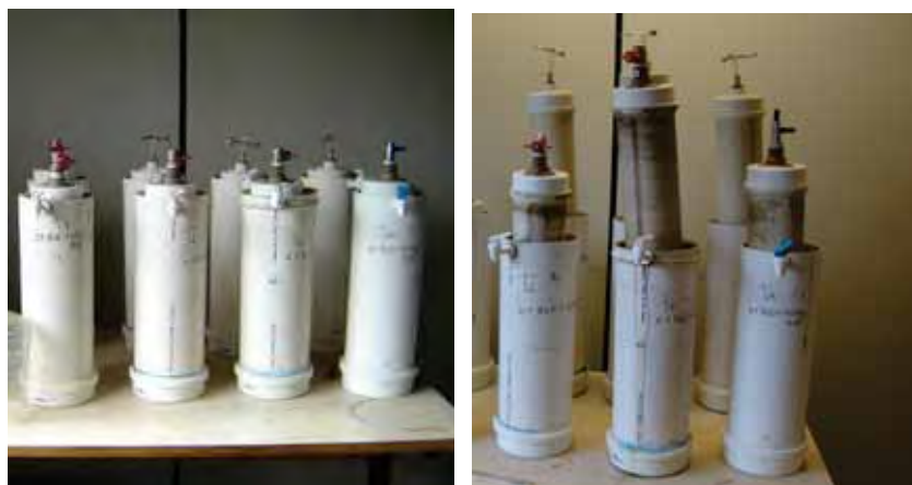
Figura 8. Vista parcial dos biodigestores batelada de bancada utilizados no ensaio de biodigestão anaeróbia com esterco de bovinos em codigestão com cana-de-açúcar e silagem de cana nas proporções 5 e 10% de vegetal
