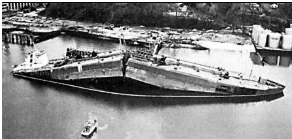
Figura 3 - Navio que fraturou de maneira frágil pela propagação de uma trinca em seu casco.
