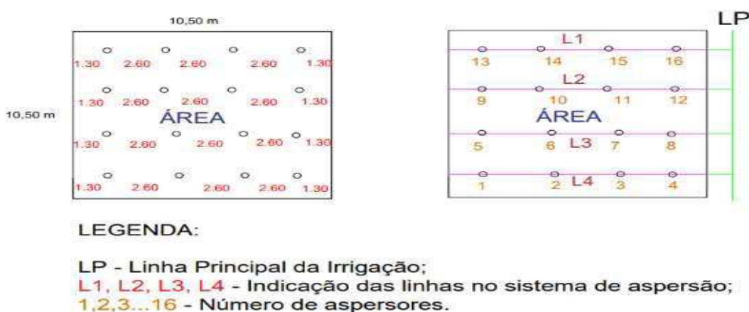
Figura 9. Disposição do sistema de microaspersão por área.
