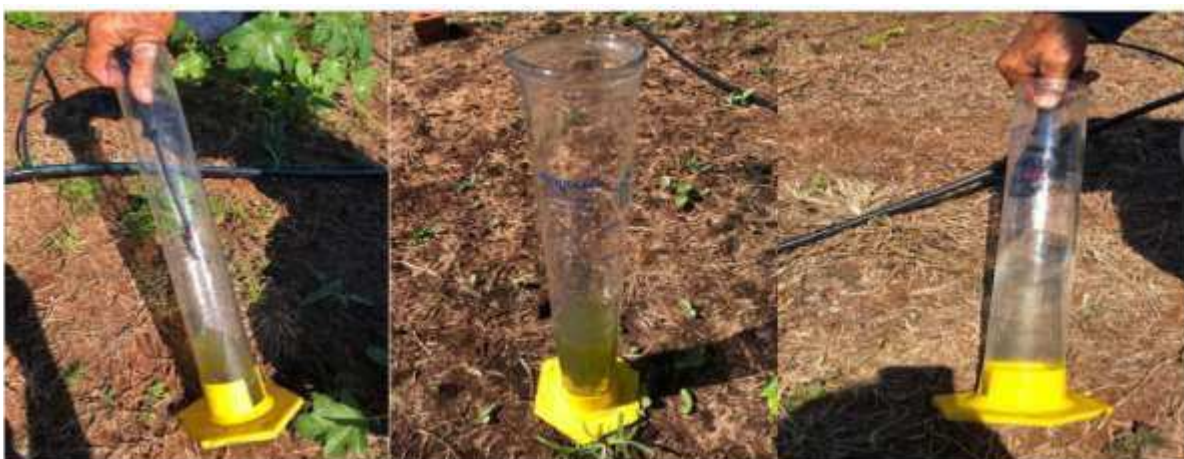
Figura 10. Teste de vazão dos microaspersores.
