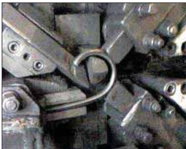
Figura 60 - Demonstração da deformação da mola durante o processo de enrolamento, deformação a frio.
