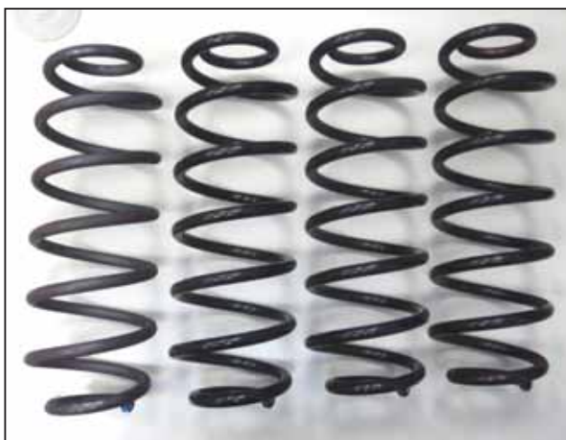
Figura 64 - Molas produzidas prontas para os ensaios, da esquerda para a direita: mola sem jateamento; mola jateada no processo P1; mola jateada no processo P2 e mola jateada no processo P3.
