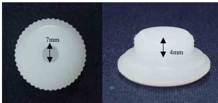
FIGURA 1 – Matriz rosqueável de teflon utilizada para a confecção dos corpos de prova.
