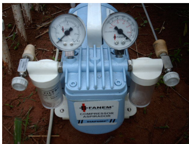
FIGURA 3. Bomba elétrica utilizada no ensaio para aplicação do vácuo aos extratores.
