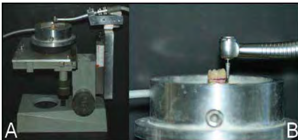
Figura 4 – Dispositivo utilizado para padronização dos preparos. A) Vista de todo o dispositivo. B) Vista aproximada.
