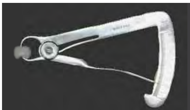
Figura 9 – Espessura da face oclusal da coroa cerâmica com 2 mm, confirmada por espécímetro.
