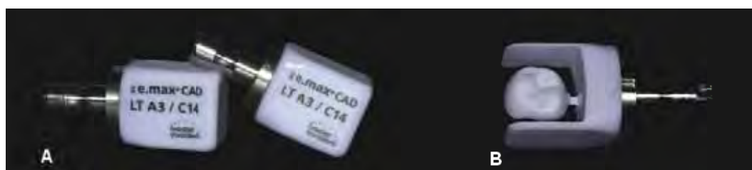
Figura 8 – Bloco cerâmicos. A) Blocos pré-sinterizados de E.max Cad. B) Coroa usinada pré-sinterizada.
