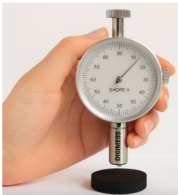
Figura 11. Medição da dureza Shore A em amostra de borracha natural vulcanizada.
