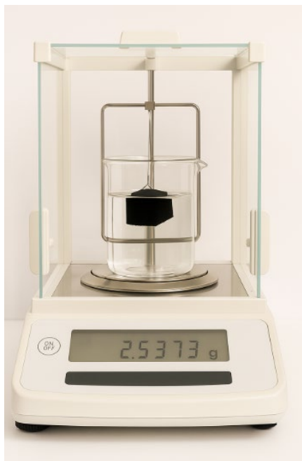
Figura 12. Equipamento utilizado para determinação da massa específica pelo método do empuxo hidrostático.
