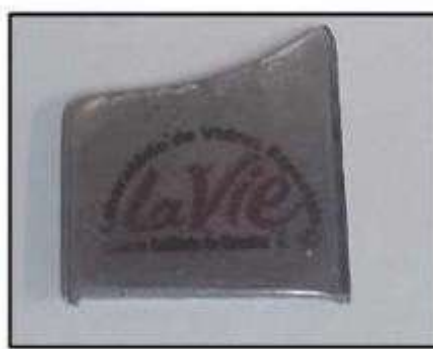
Figura 28- Vidro fluorofosfato contendo 0,29% de CoPt@SiO 2 em massa.
