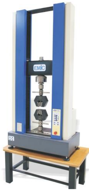
Figura 2: Imagem fotográfica da máquina de ensaio universal EMIC® DL 10000 utilizada para as análises mecânicas. (Fonte: Emic®)
