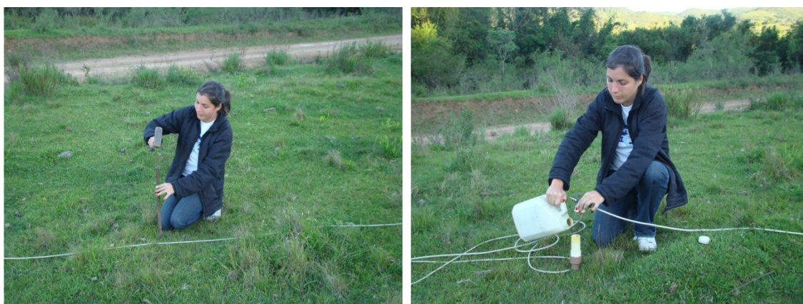
Foto 6 – Perfuração, fixação e preenchimento de um eletrodo de leitura.
