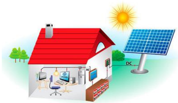
Figura 14 - Sistema fotovoltaico isolado.
