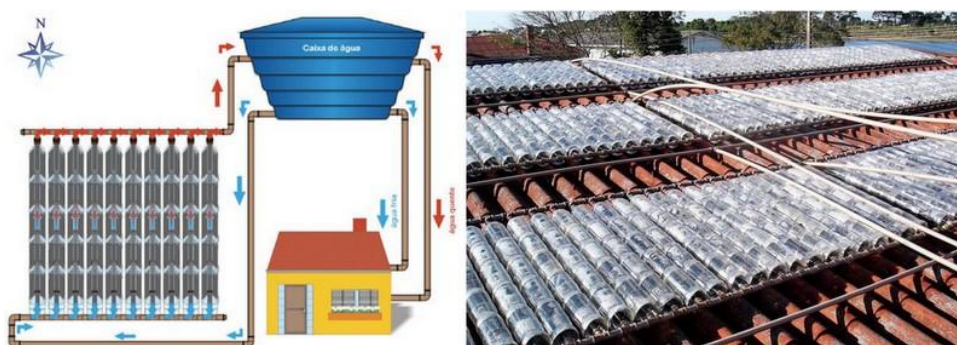
Figura 15 - Aquecedor solar feito com garrafas pets.
