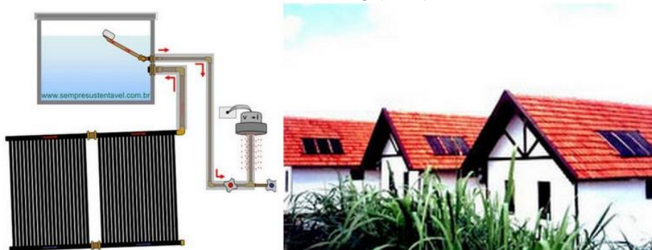
Figura 16 - Aquecedor solar de tubos ou placas de PVC.
