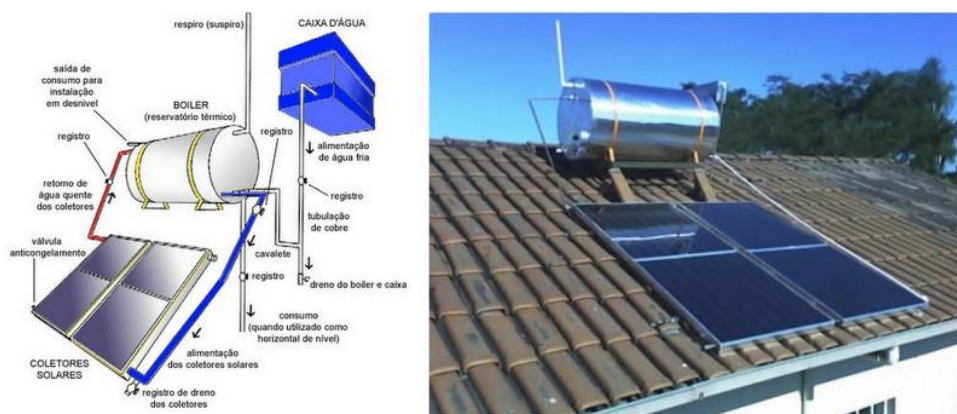
Figura 17 - Aquecedor solar tradicional. Fonte: Produção civil; Maquina de sites; (2013)
