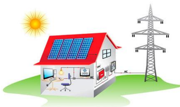
Figura 13 - Sistema fotovoltaico conectado à rede.
