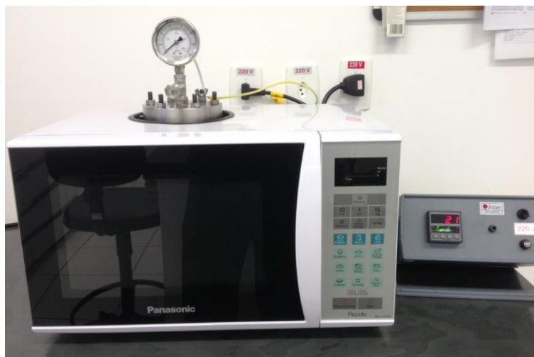
Figura 9 – Aparato de micro-ondas empregado para sínteses hidro/solvotérmicas. A imagem mostra a cavidade do micro-ondas contendo o reator de PTFE selado com tampa de aço inoxidável, e, ainda, o controlador de temperatura à direita.
