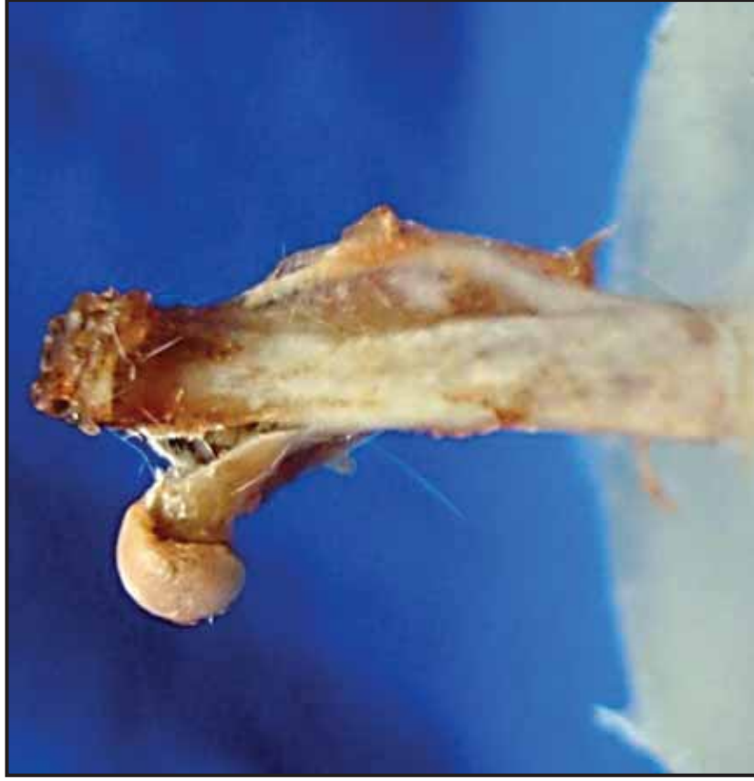
Figura 3b – Detalhe do corpo de prova após a realização do ensaio mecânico e a ruptura do corpo de prova.
