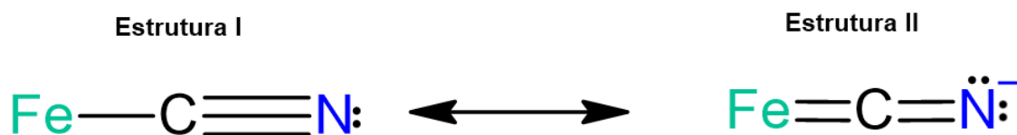
Figura 11 - Estrutura de ressonância metal - ligantes dos complexos de ferro
