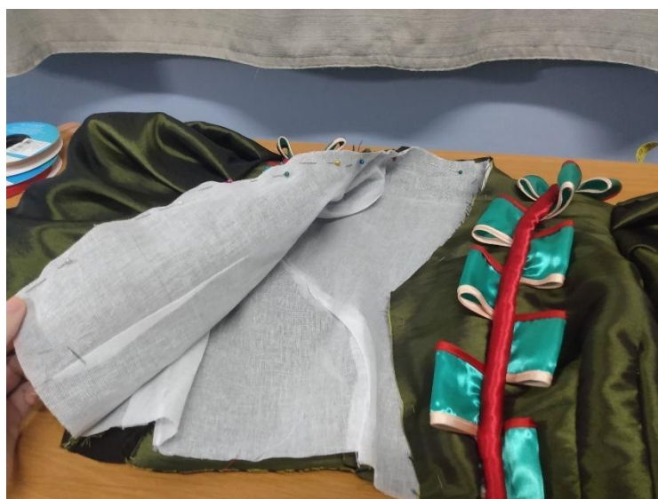
Figura 96 – Fixação do forro.
