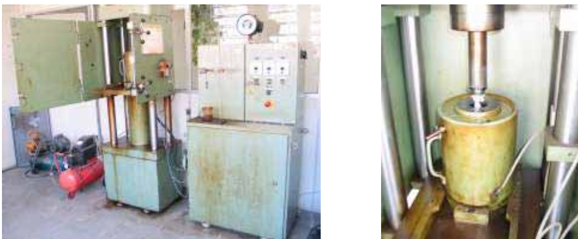
Figura 18 - Prensa isostática a frio (Paul Weber) utilizada neste trabalho.
