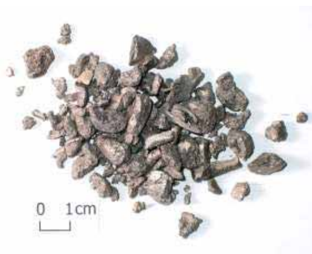
Figura 11 - Aspecto dos finos de esponja utilizados para obtenção de pó de titânio.
