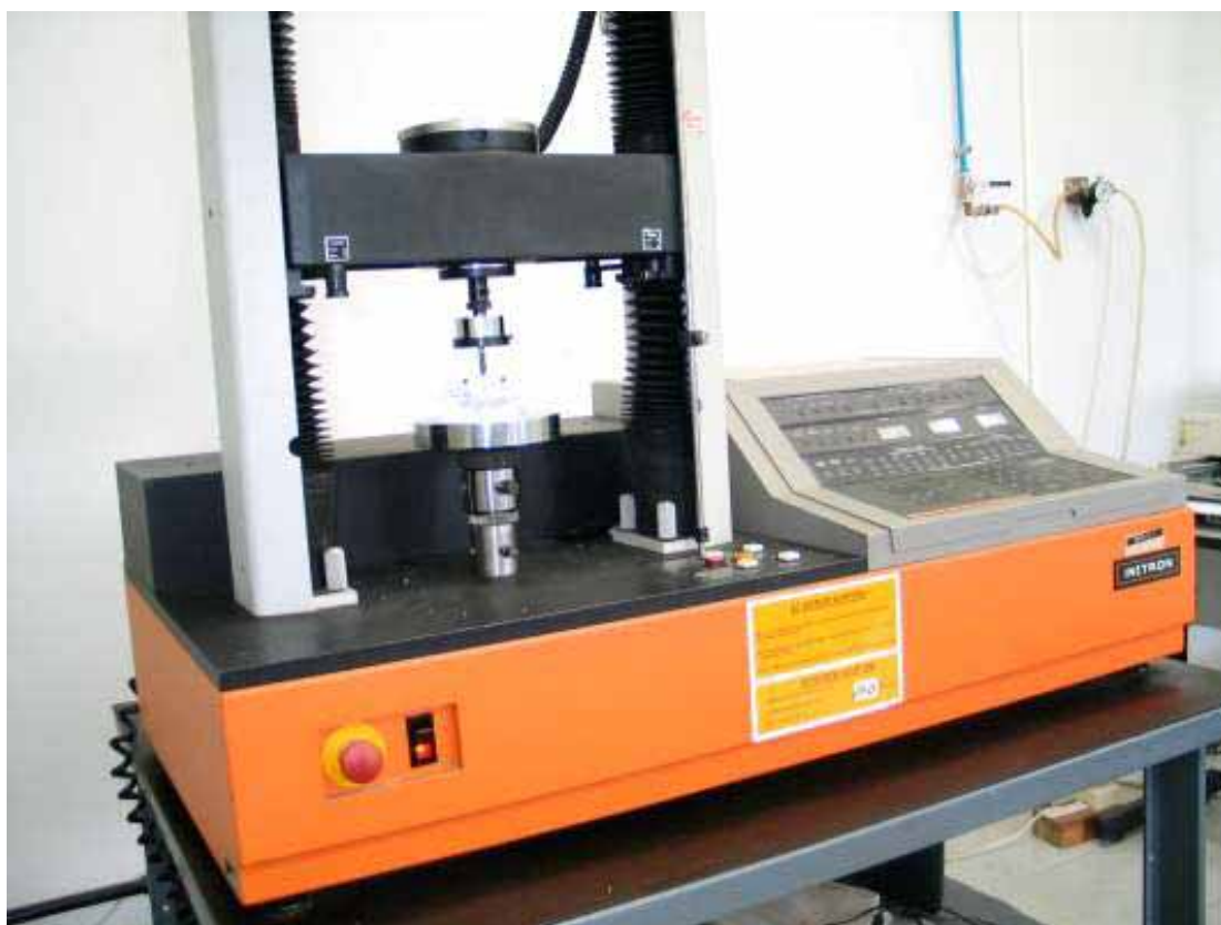
Figura 20 - Detalhes da máquina de ensaio INSTRON modelo 4301 utilizada para ensaio da liga Ti-35Nb, em flexão de três pontos, à temperatura ambiente.
