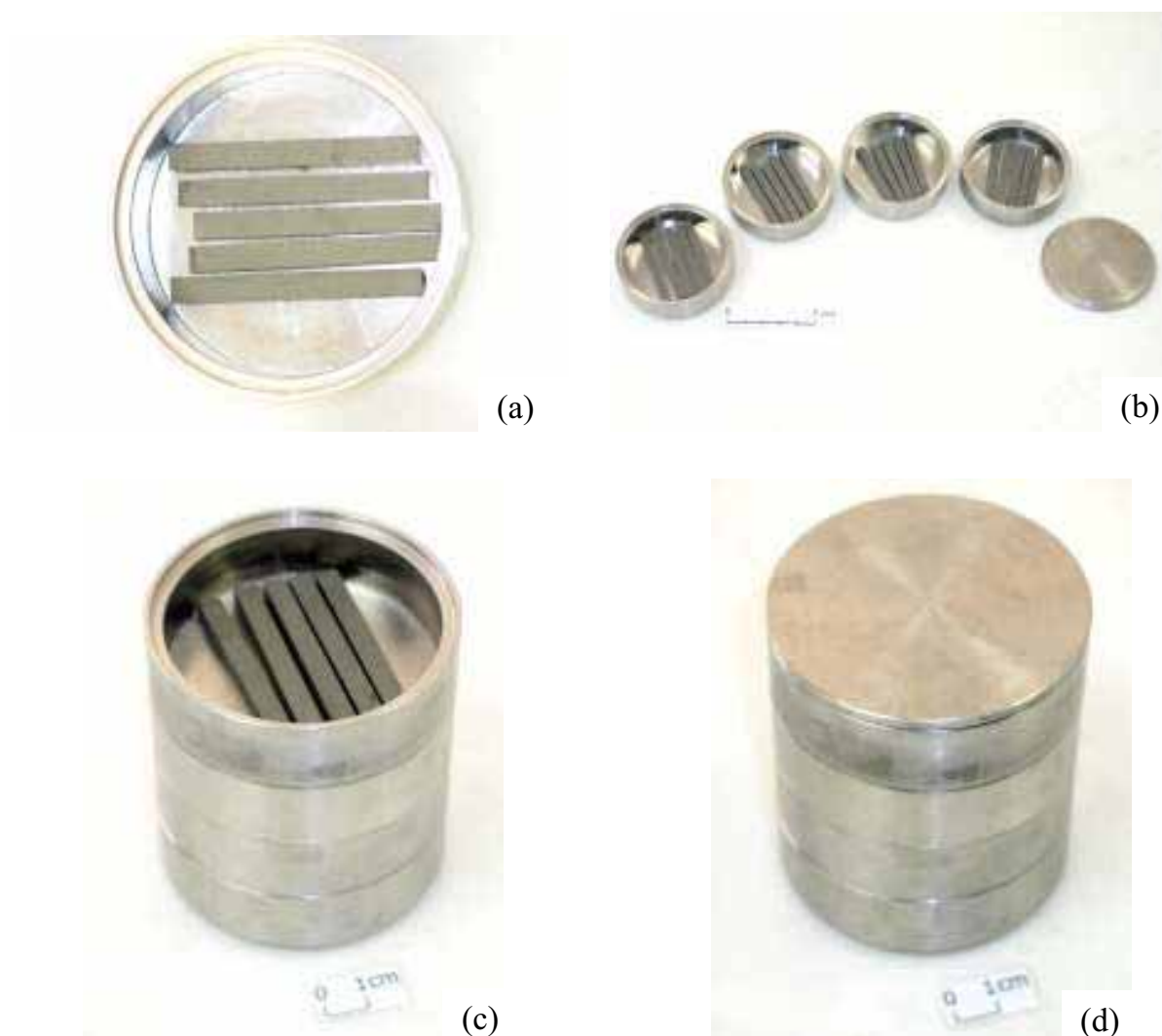
Figura 19 - Detalhes do cadinho e da forma de carregamento dos corpos-de-prova para sinterização. (a) detalhe dos corpos-de-prova; (b) conjunto dos cadinhos; (c) montagem dos cadinhos; e (d) montagem final.
