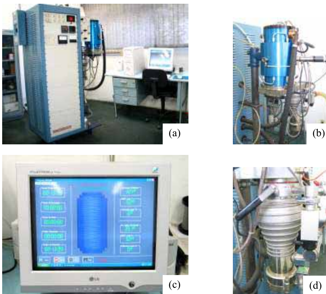
Figura 12 (a-d) - Fotografias. Forno utilizado para hidrogenação e sinterização: (a) vista geral, (b) forno e pirômetro óptico, (c) sistema de aquisição de dados e (d) sistema de vácuo (bomba difusora).
