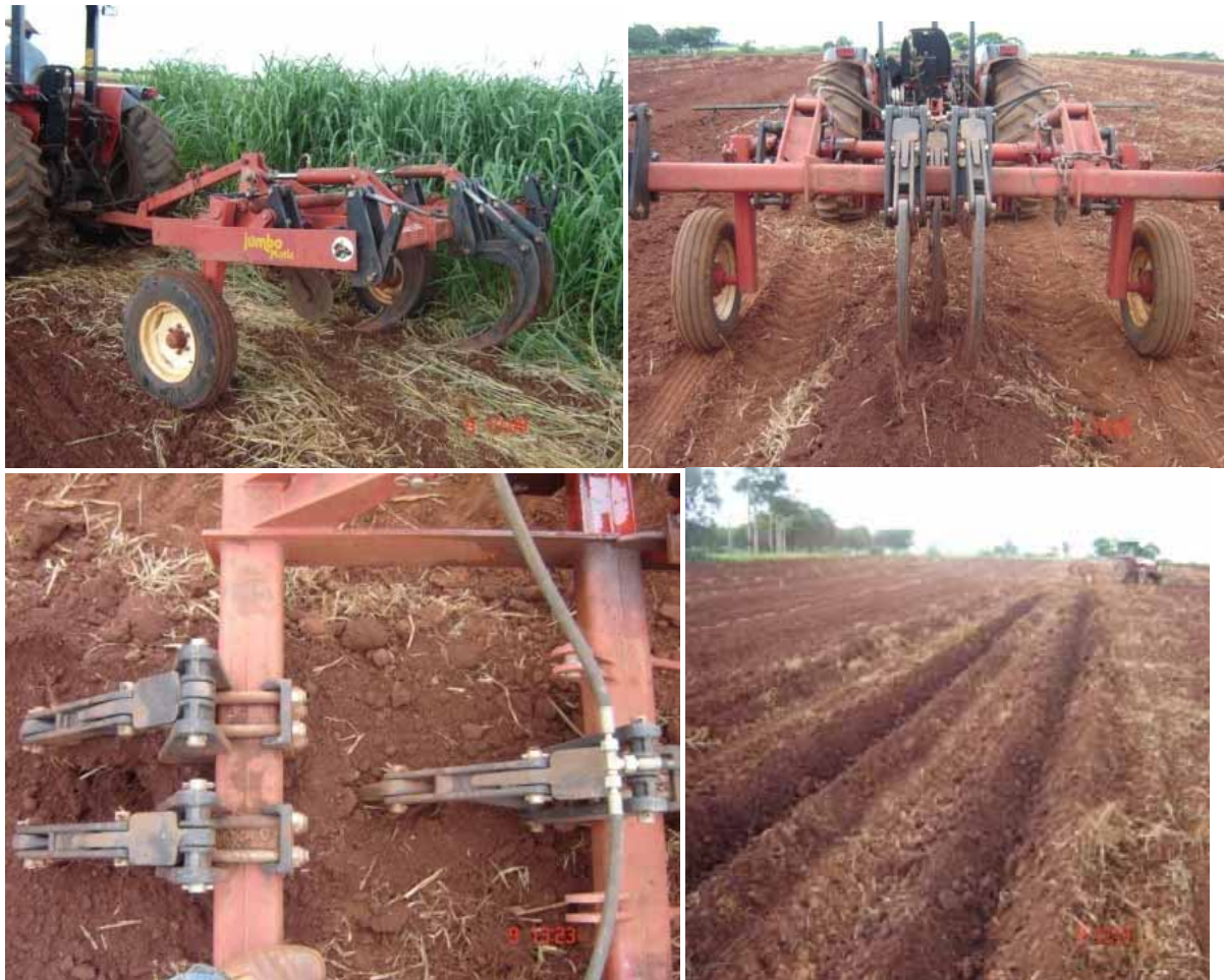
Figura 1- Subsolador de 3 hastes utilizado e sulcos abertos para o preparo das covas. Selvíria – MS, 2010.
