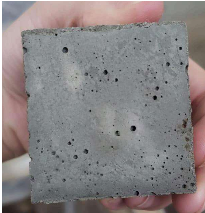
Figura 11. Corpo-de-prova do ensaio de compressão com concentração de 3% PET distribuição aleatória.
