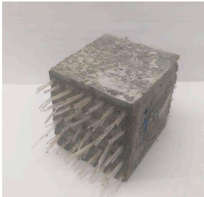
Figura 10. Corpo-de-prova do ensaio de compressão com concentração de 3% FO distribuição ordenada, antes dos cortes de fibras.
