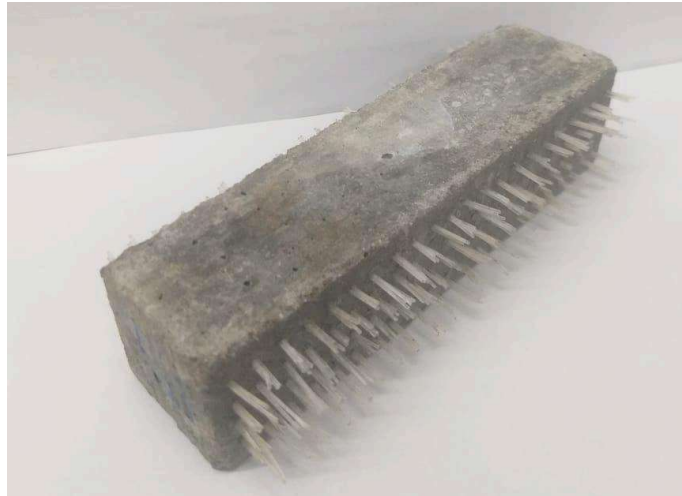
Figura 9. Corpo-de-prova do ensaio de tração com concentração de 3% FO distribuição ordenada, antes dos cortes de fibras.
