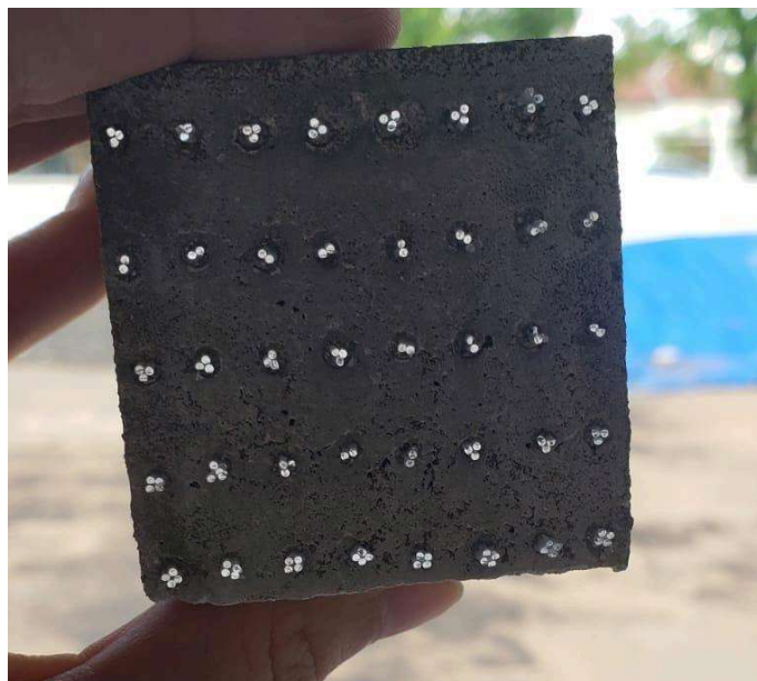
Figura 12. Corpo-de-prova do ensaio de compressão com concentração de 3% FO distribuição ordenada, fibras cortadas.
