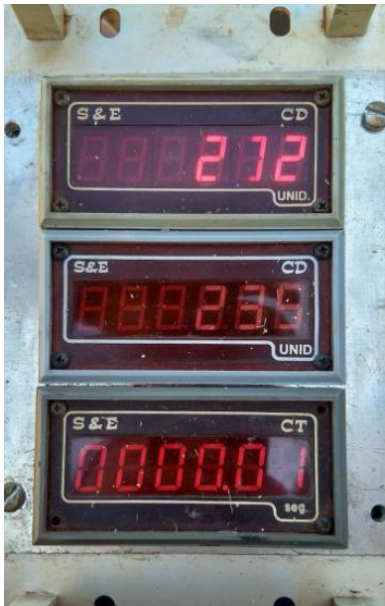
Figura 8 – Painel para monitoramento e aquisição de dados
