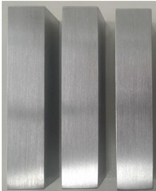
Figura 37 - Corpos de prova para ensaio de HIC após lixamento
