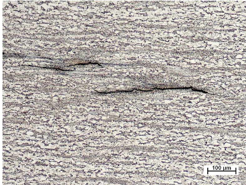
Figura 9 - Trinca induzida por hidrogênio em aço API
