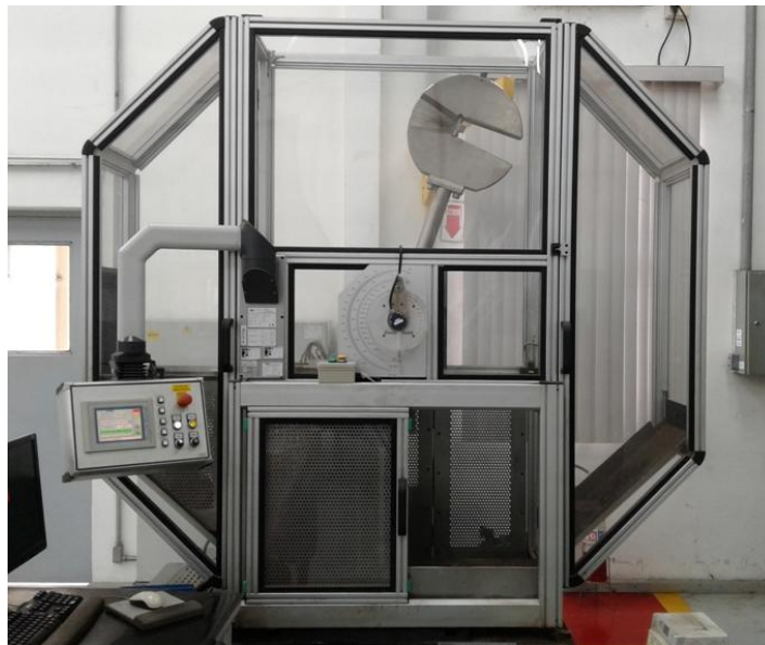
Figura 35 - Máquina de ensaio de Charpy Zwick-Roell
