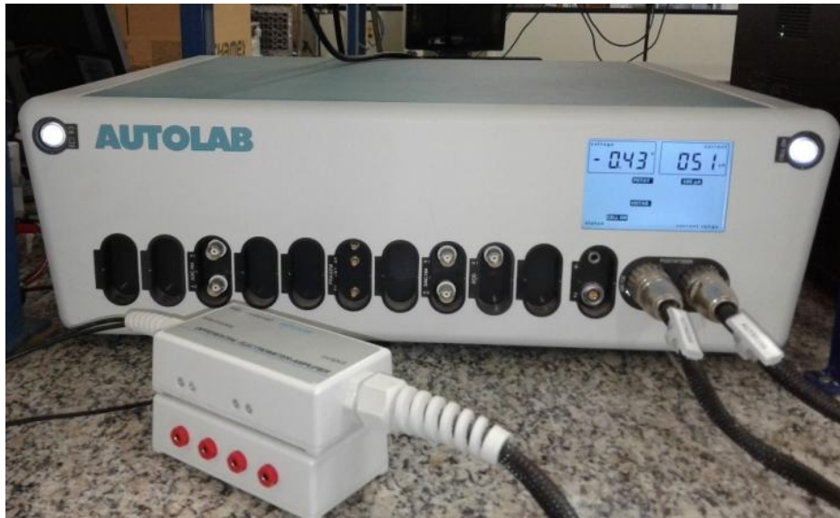
Figura 48 - Potenciostato/galvanostato Autolab PGSTAT302
