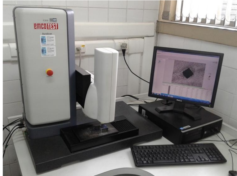
Figura 33 - Máquina de dureza Vickers EMCOTEST
