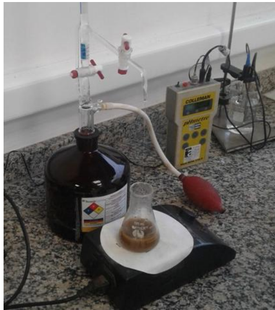
Figura 51 - Processo de titulação iodométrica
