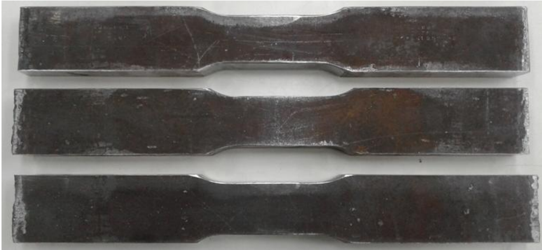
Figura 30 - Corpos de prova prismáticos para ensaio de tração
