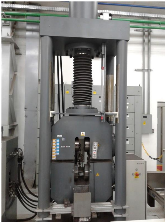
Figura 31 - Máquina de tração Zwick-Roell
