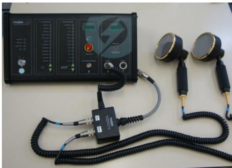
Figura 6. Unidade de controle e clusters do equipamento de LED (THOR-LX2).
