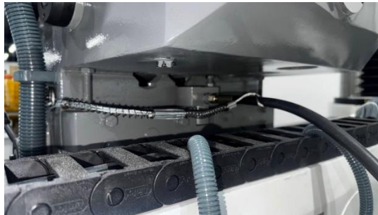
Figura 55 – Cabos de aço para contenção de mangueiras na face traseira superior da máquina próximo à caixa de engrenagens
