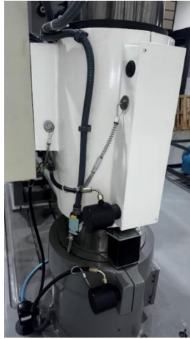
Figura 54 – Cabos de aço para contenção de mangueiras na face esquerda da máquina
