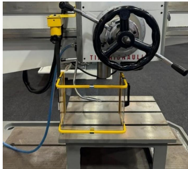
Figura 12 – Proteção do mandril não monitorada vinda do fabricante
