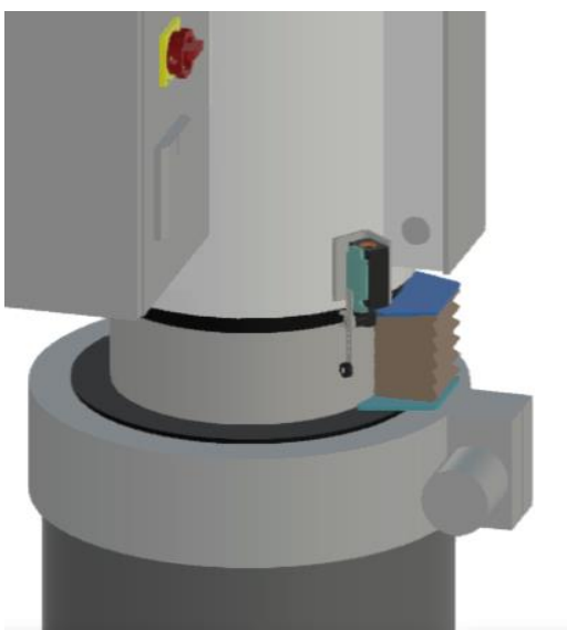
Figura 18 – Projeto 3D de sensor fim de curso e proteção sanfonada para limitar movimento vertical em seu limite inferior
