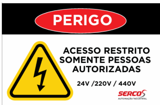
Figura 26 – Placa de aviso de perigo para painel elétrico
