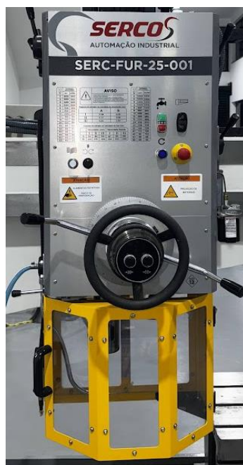
Figura 34 – Proteção mecânica do mandril implementada
