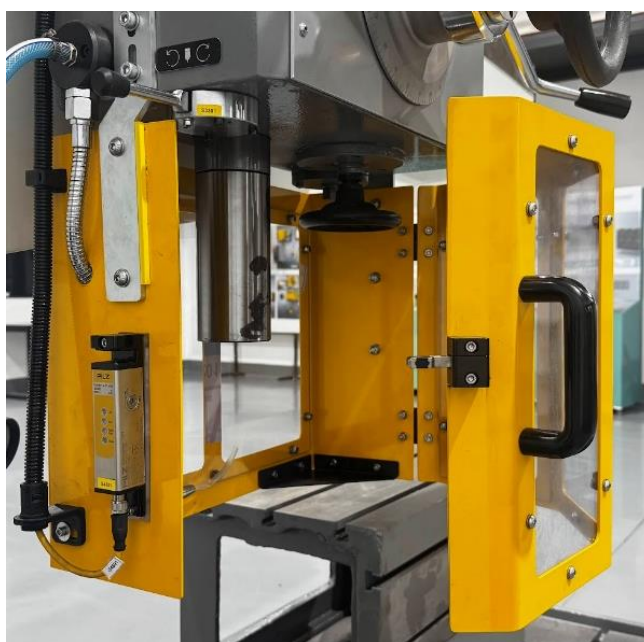
Figura 35 – Chave de segurança de intertravamento da proteção do mandril
