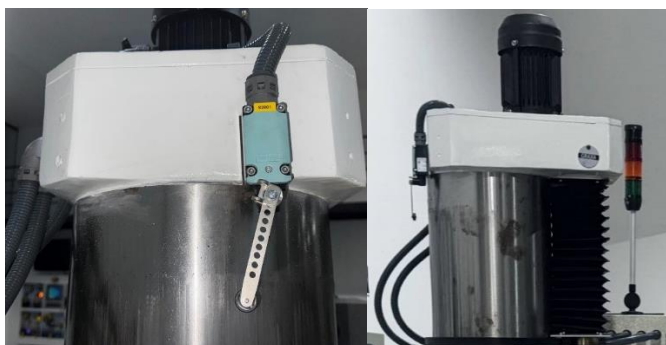
Figura 37 – Sensor fim de curso e proteção sanfonada para limite vertical inferior
