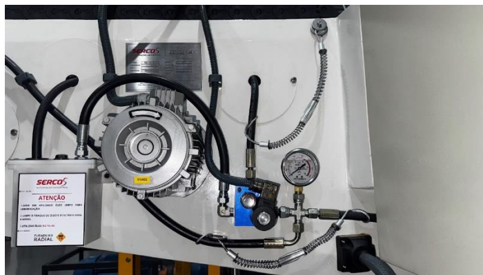
Figura 56 – Cabos de aço para contenção de mangueiras na face traseira superior da máquina
