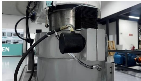
Figura 52 – Cabos de aço para contenção de mangueiras na face esquerda inferior da máquina
