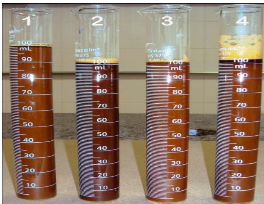
Figura 12. Ensaio de floculação após 15 minutos a temperatura ambiente: (1) CAT-1 e (2 a 4) UAM.
