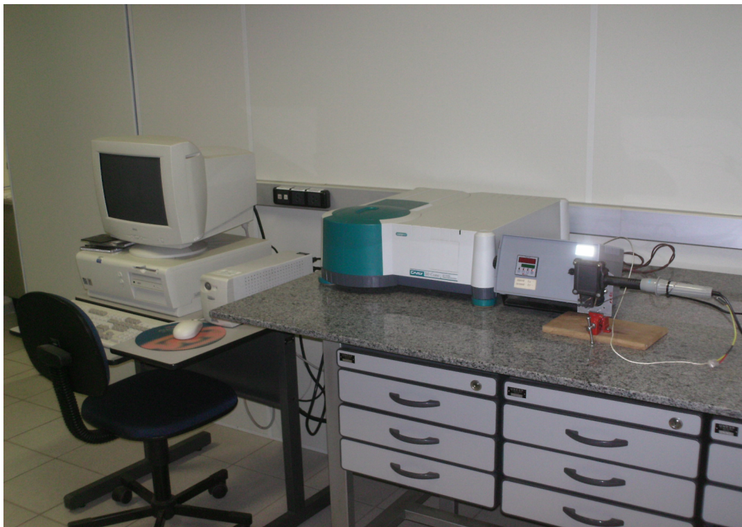
Figura 8: Foto do espectrofotômetro utilizado na aquisição dados e o controlador utilizado para tratamento térmico.
