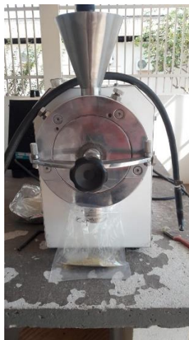
Figura 5. Moinho tipo Wiley para moagem das amostras.
