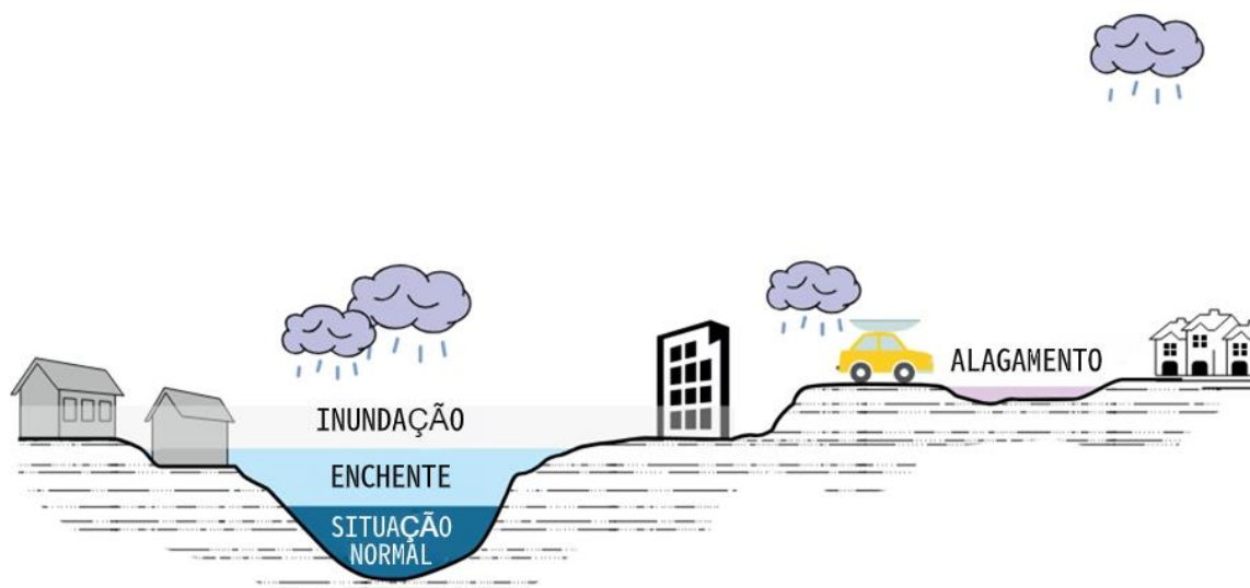
Figura 46 – Representação dos fenômenos de alagamento, enchente e inundação
