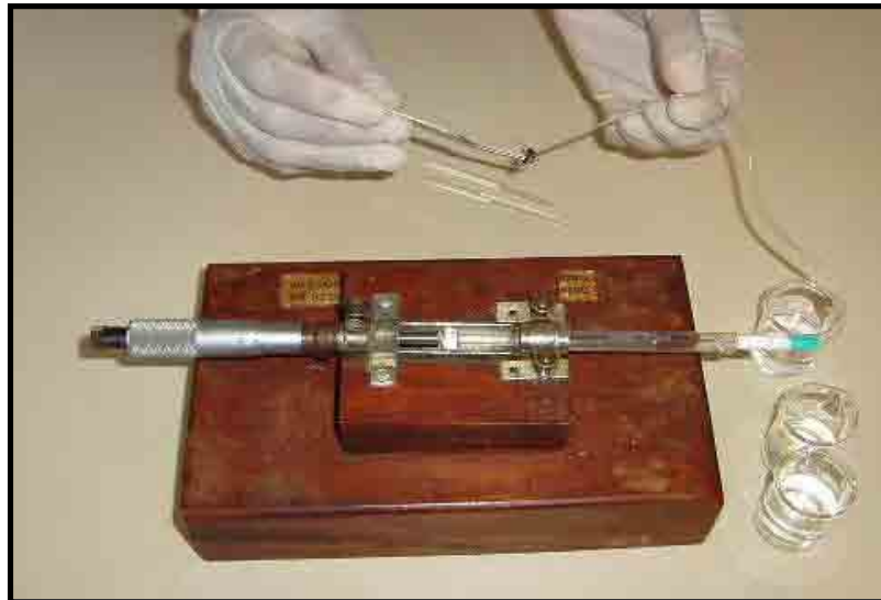
Figura 12: Operária de Atta sexdens rubropilosa recebendo 1\mu\text{L} do tratamento no pronoto com o auxílio de uma microseringa adaptada a um micrômetro.
