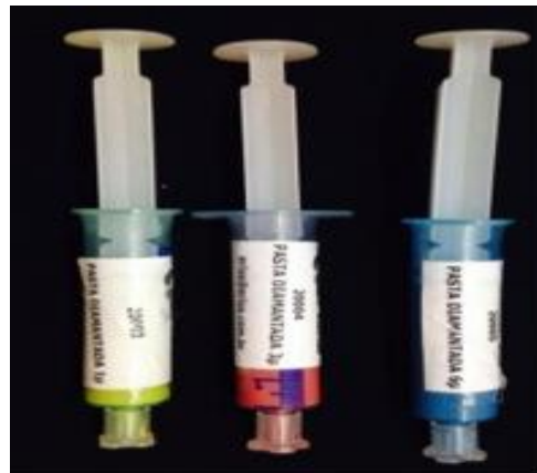
Figura 12 - Pastas diamantadas (1, 3 e 6μm).
