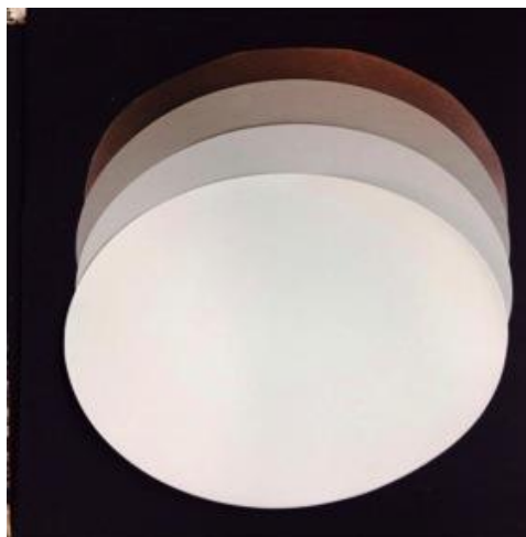
Figura 10 - Lixas abrasivas de granulação 320, 600, 800 e 1200.
