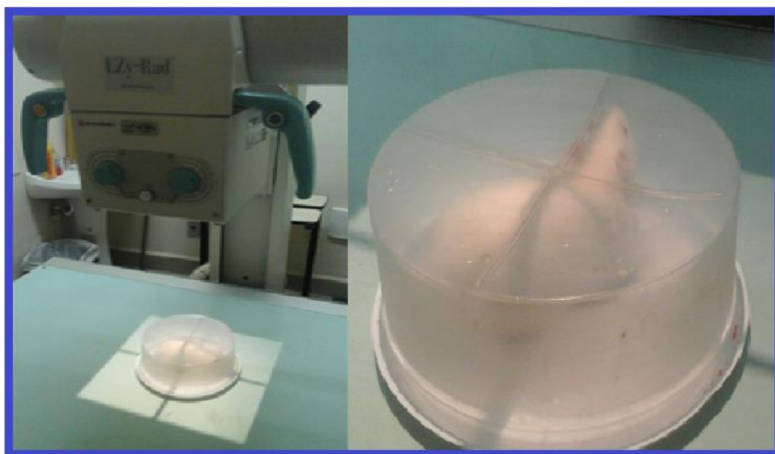
Figura 11: Posicionamento dos animais durante a exposição, detalhe do dispositivo de contenção para irradiação do animal.
