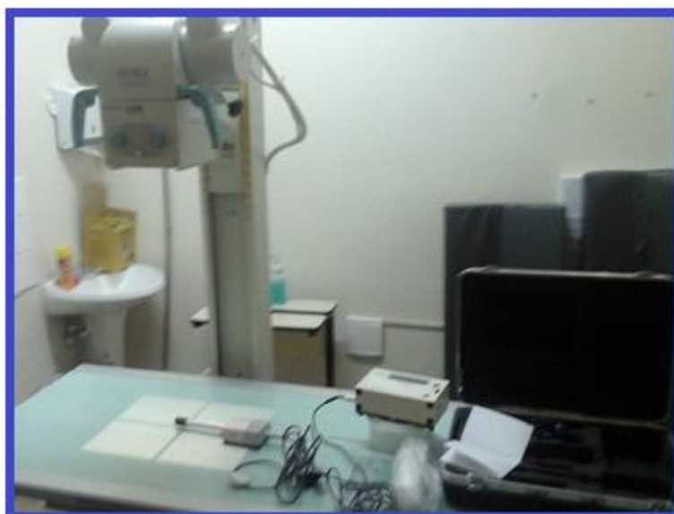
Figura 13: Medidas de Kerma no ar do aparelho de raios X.
