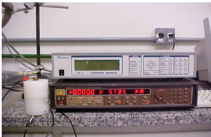
Figura 24- Equipamento de tensão pulsada estabilizadora Keithley 237
