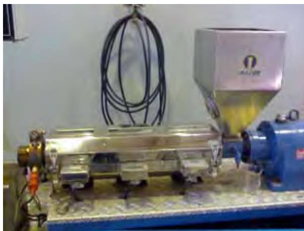
Figura 3.11 Extrusora usada para obtenção dos compósitos
