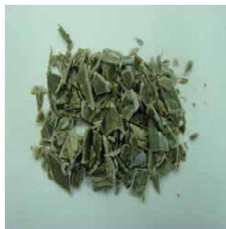
Figura 3.5 (a) Moinho granulador; (b) compósito moído
