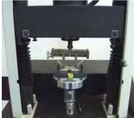
Figura 3.8 Dispositivo usado para o ensaio de flexão
