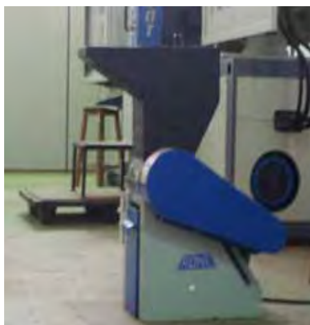
Figura 3.5 (a) Moinho granulador; (b) compósito moído
