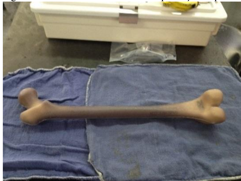
Figura 18 - Fêmur sintético antes da implantação da prótese
