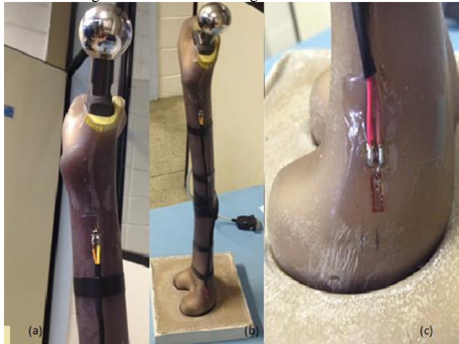
Figura 21 – Locais da colagem do extensômetro
