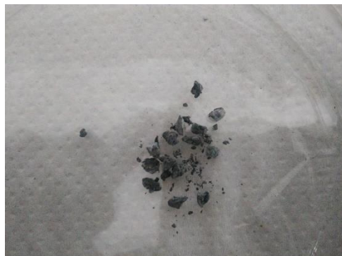
Figura 5. Óxido de grafeno reduzido quimicamente
