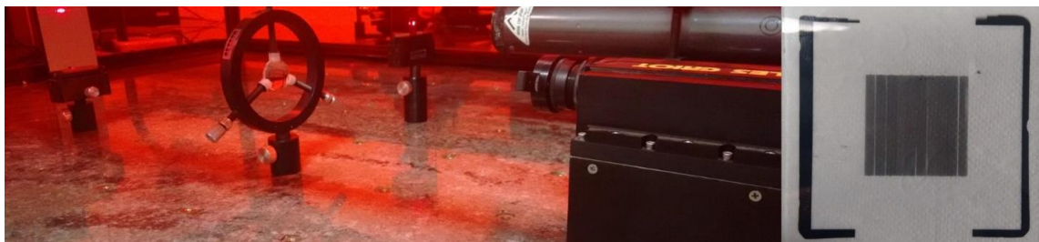
Figura 39 - Esquema de gravação das redes de difração utilizando uma máscara com períodos de 50 \mu\text{m} .
