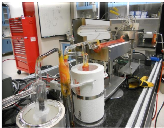
Figura 11 - (a) Esquema experimental para a preparação do vidro calcogeneto. (b) Foto do sistema utilizado. (Foto cedida pela Dra Sandra Messaddeq).
