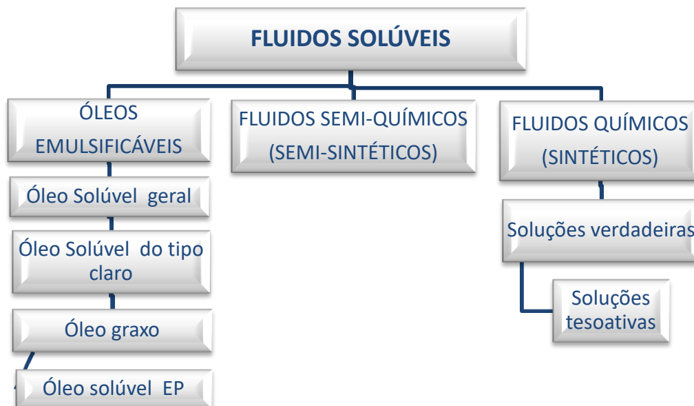
Figura 2.9. Classificação dos fluidos solúveis em água (Adaptado de EL BARADIE, 1996).
