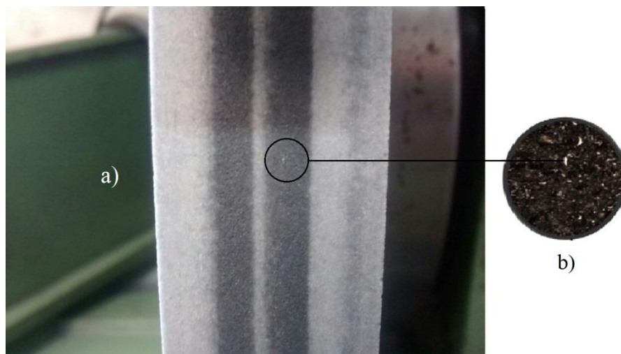
Figura 2.13. Ilustração a) “borra” no rebolo composta entre óleo e cavaco, b) ampliação da área do rebolo em (a)
