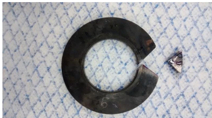
Figura 3.15. Representação do corte da amostra do corpo de prova e retirada de material para as análises de Metalografia e determinação de Microdureza.
