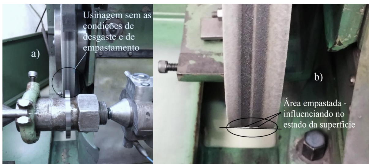
Figura 4.6. (a) Ensaio com a vazão (Q) 30 ml/h (S/L) (b) Topografia da superfície de corte do rebolo.
