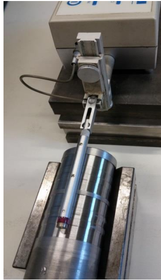
Figura 3.14. Instrumento utilizado na medição de desgaste diametral do rebolo através da altura dos degraus do corpo de prova.
