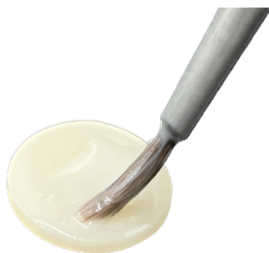
Figura 3 – Aplicação de vidro experimental sobre superfície de 5Y-PSZ pré-sinterizada através da técnica de pincelamento
