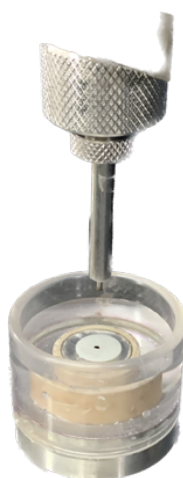
Figura 5 – Dispositivos em espécime para o teste de flexão biaxial
