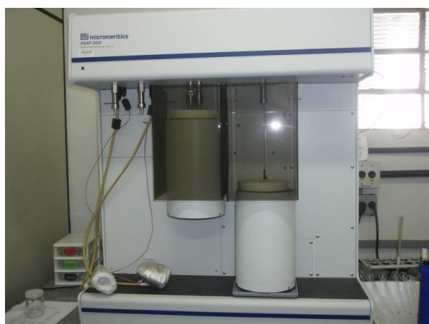
Figura 7 – Porosímetro de Adsorção de N 2 (ASAP 2020), disponível no LETef-USP/EESC.
