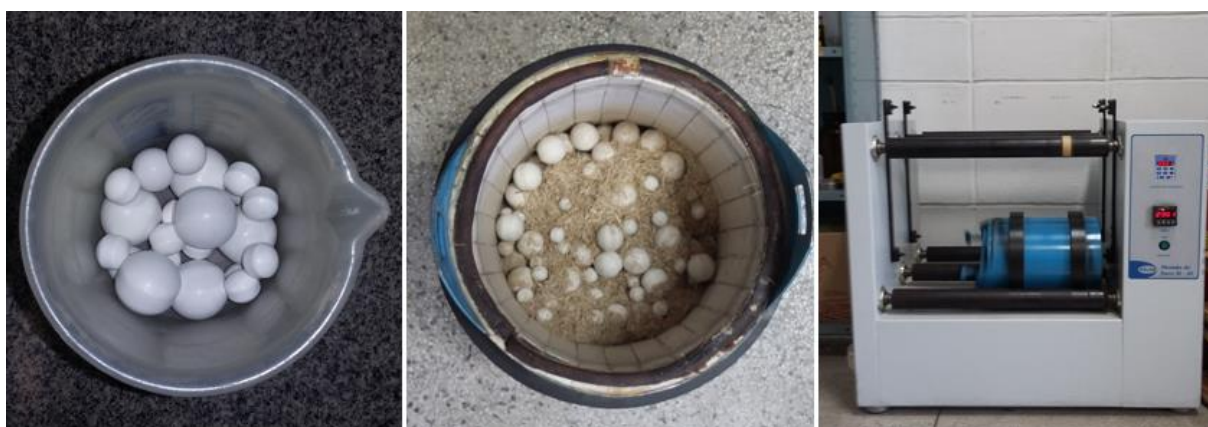
Figura 4 - Moinho de jarro Solab SL-35 e bolas de alumina, disponível no Laboratório de cerâmicos do Departamento de Materiais, FEG/UNESP.
