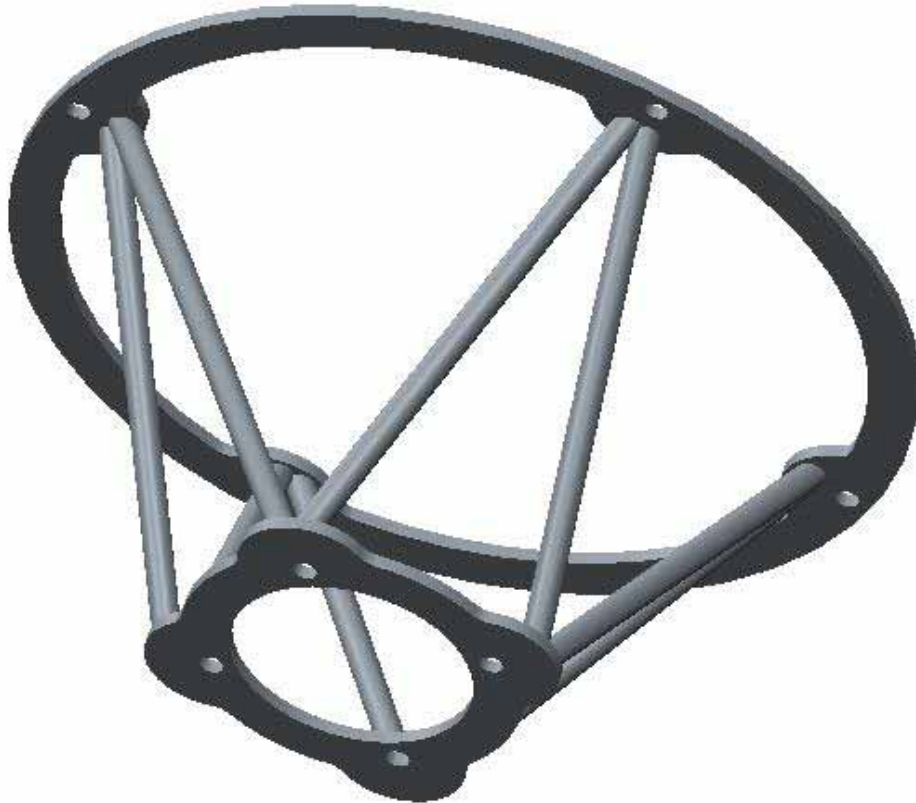
Figura 11 – Sistema de Ancoragem validado em análise por elementos finitos
