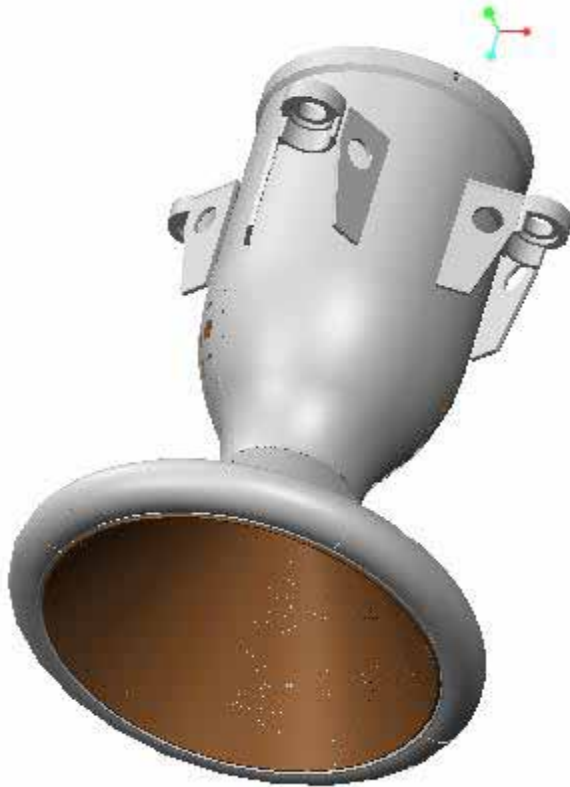
Figura 10 – Modelo conceitual de uma câmara de combustão
