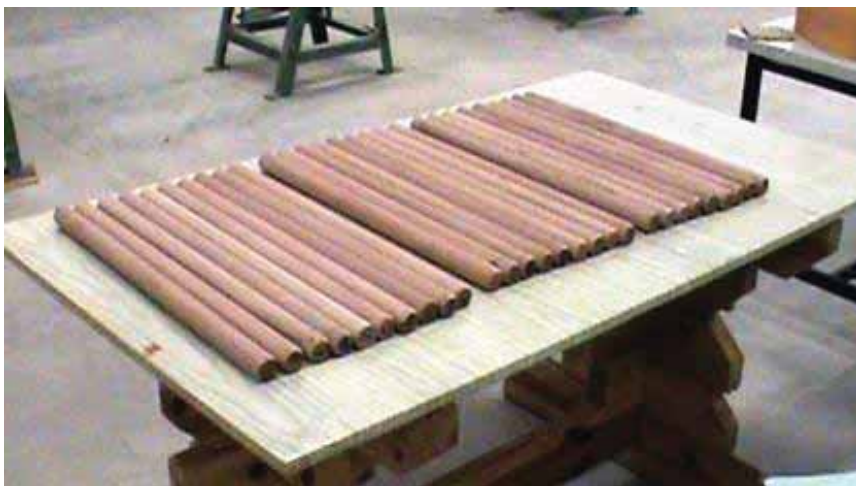
Figura 16 - Corpos de prova preparados para os ensaios de lixamento.
