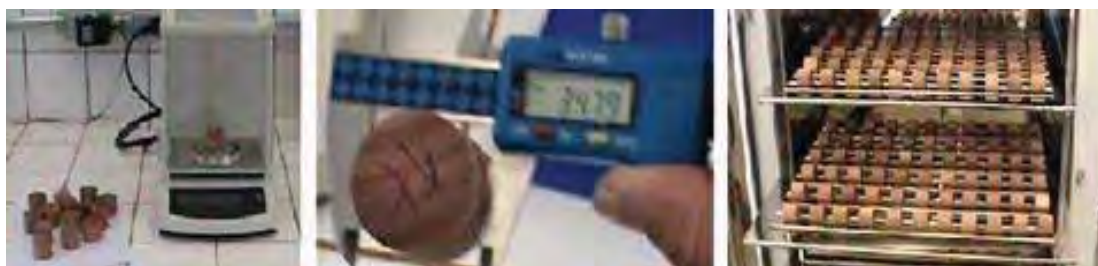
Figura 30 - Amostras utilizadas para a determinação da densidade aparente e umidade dos corpos de prova.
