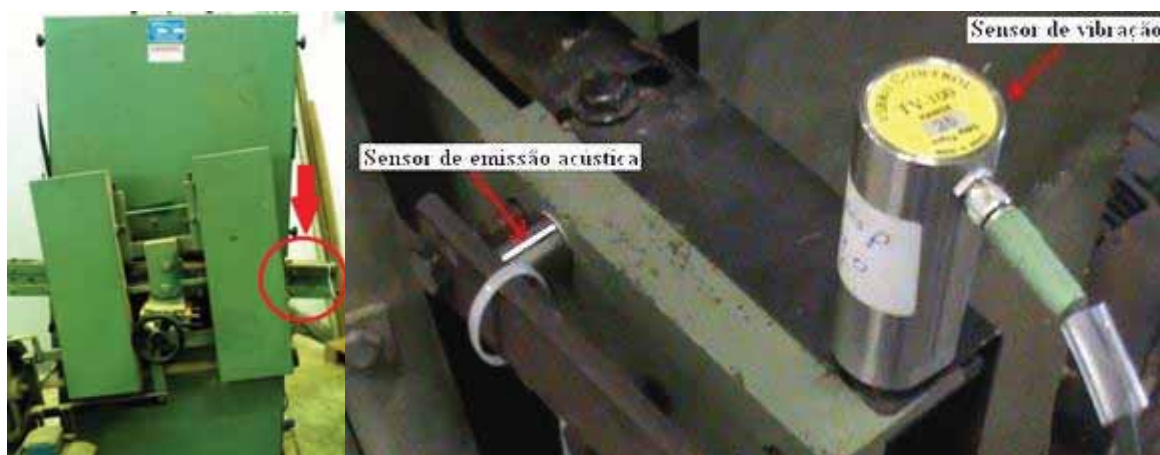
Figura 22 – Posicionamento dos sensores de emissão acústica e de vibração.
