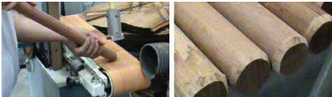
Figura 15 - Lixamento de uma das extremidades dos corpos de prova.
