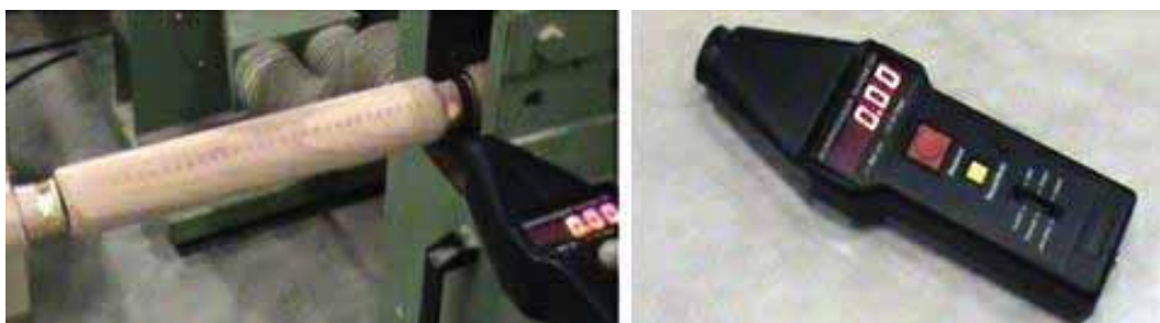
Figura 26 - Tacômetro óptico marca Dynapar, modelo HT 100.
