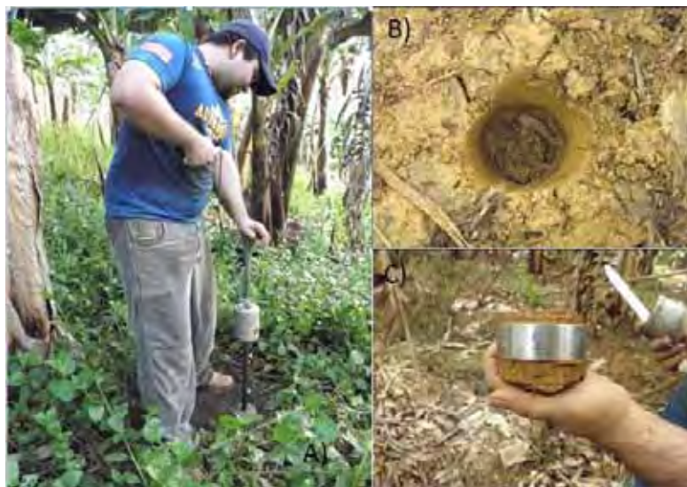
Figura 9. Detalhe da amostragem. Utilização do amostrador de Uhland (A); detalhe do local amostrado (B) e amostra indeformada coletada (C).
