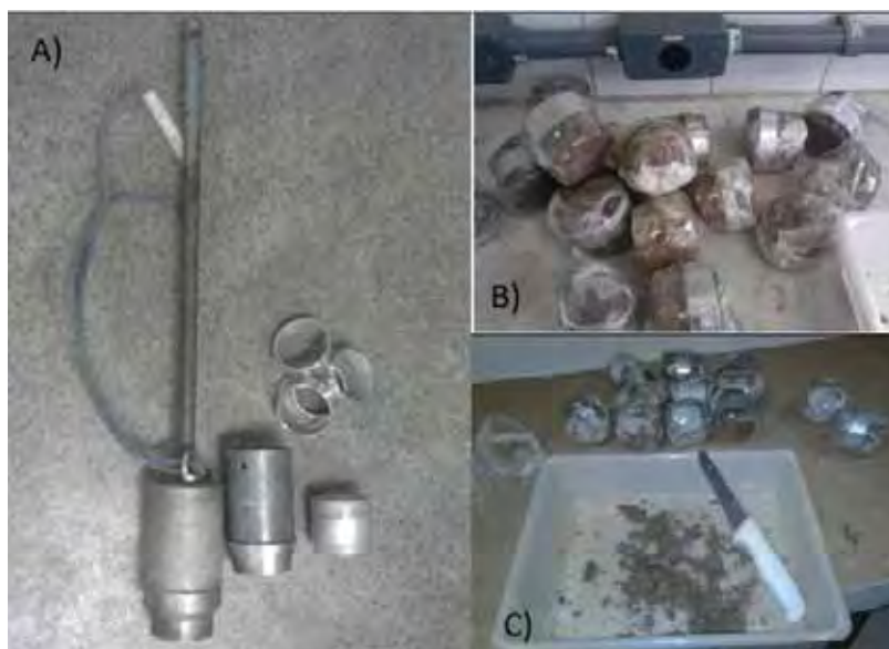
Figura 8. Equipamentos utilizados e amostras no laboratório. Amostrador de Uhland (A); amostras prontas para serem moldadas (B) e após moldar um dos anéis (C).
