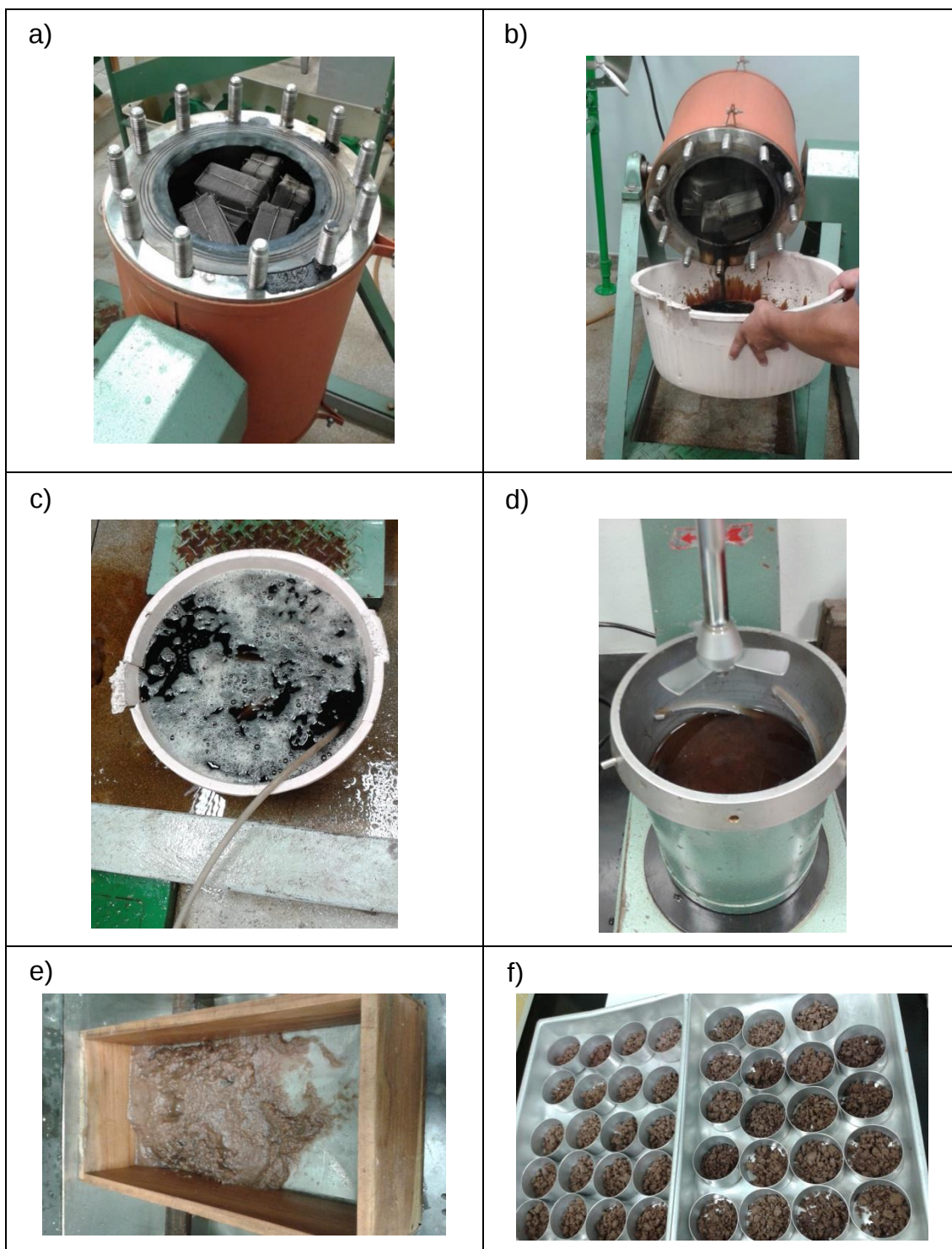
Figura 8. Cozimento Kraft; a) digestor rotativo com cápsulas preenchidas de cavacos; b) retirada do licor negro do digestor após cozimento; c) lavagem dos cavacos nas cápsulas para retirada do licor negro; d) equipamento desintegrador Regmed D-3000; e) celulose desintegrada em fôrma com peneira; f) celulose desintegrada em forminhas para verificação do teor a seco em estufa
