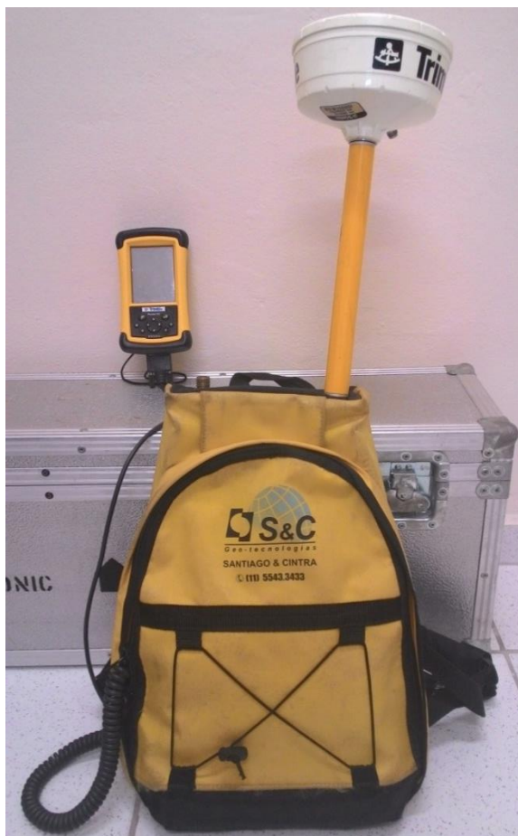
Figura 39. GPS Diferencial utilizado no levantamento do posicionamento geográfico e altitude das estações gravimétricas.
