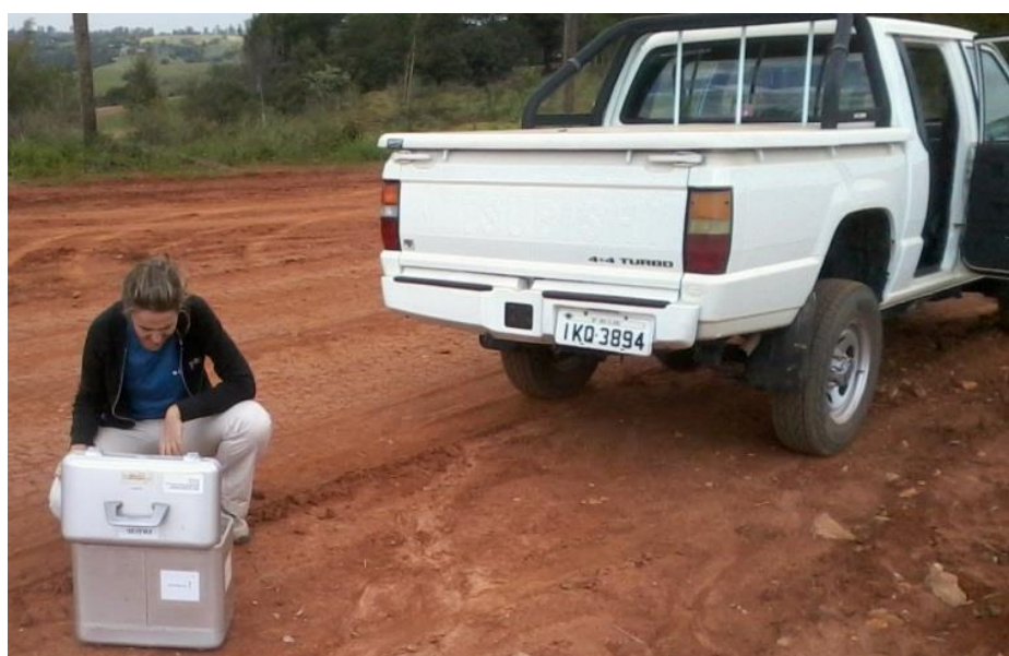
Figura 42. Levantamento de campo - leitura da gravidade relativa.
