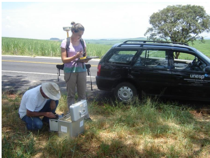
Figura 44. Levantamento gravimétrico e coleta do posicionamento (DGPS).
