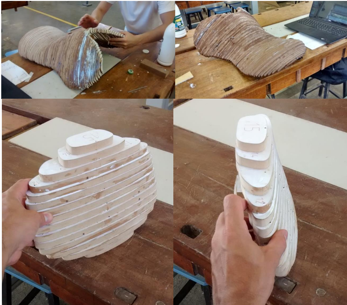
Figura 43 processo de montagem e colagem das partes do assento e do apoio anterior de tronco do mocho
