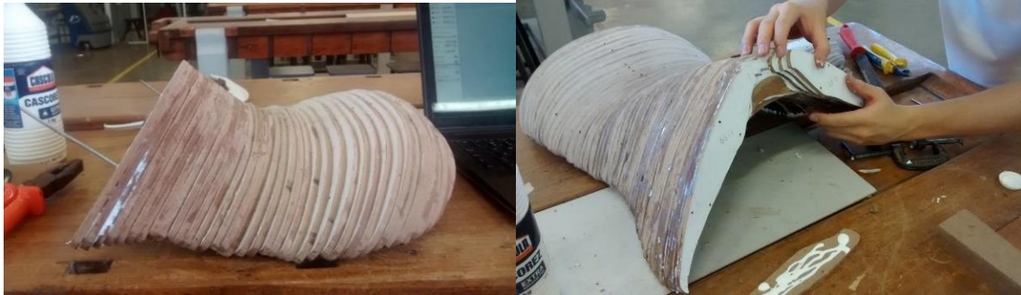
Figura 43 processo de montagem e colagem das partes do assento e do apoio anterior de tronco do mocho
