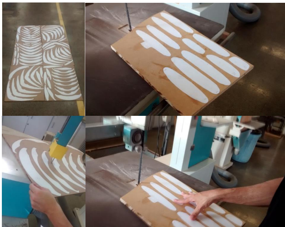
Figura 40 fatias impressas e coladas na chapa de MDF e posterior corte da chapa.
