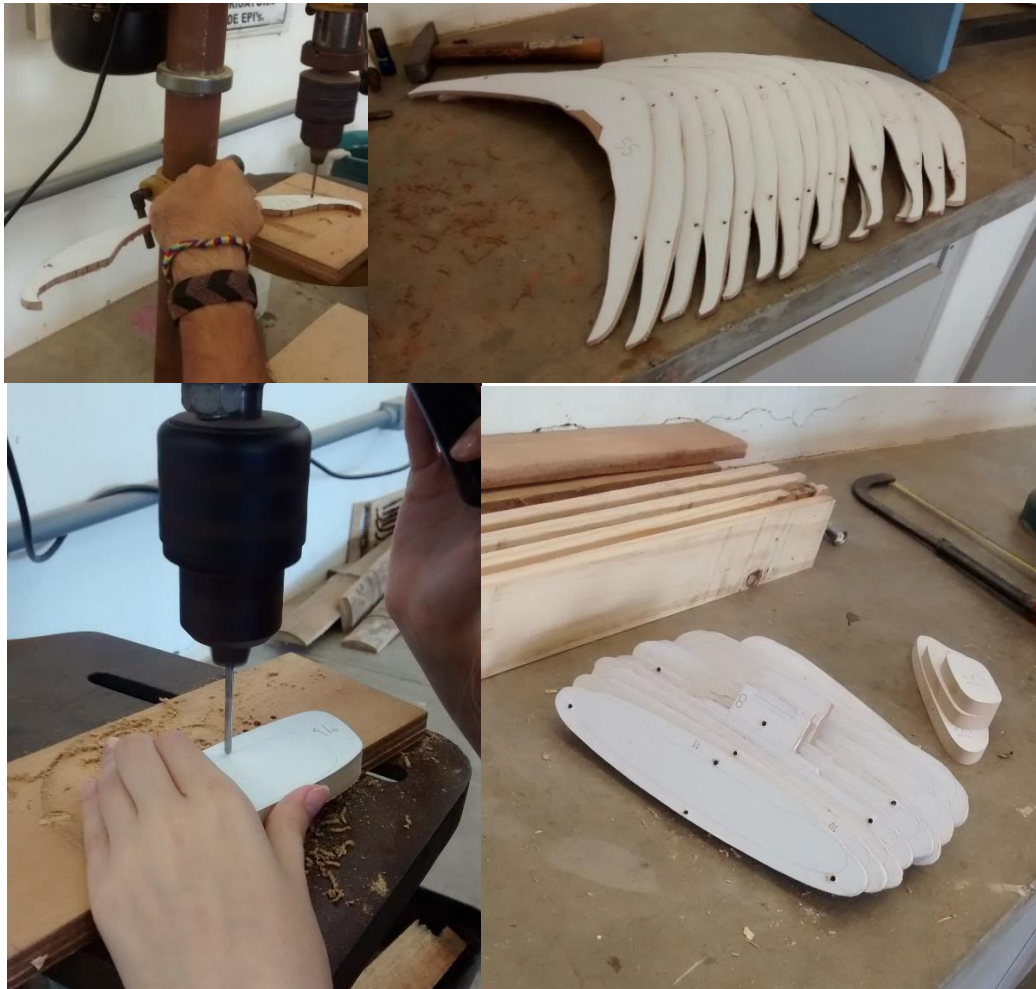
Figura 41 Furação dos pontos guia e separação das peças em ordem de colagem.
