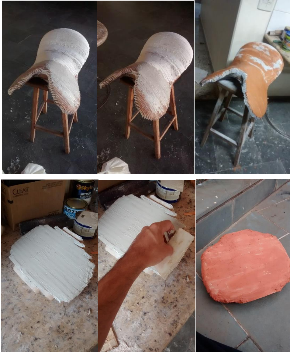
Figura 45 Processo de diferentes tipos de massa plástica para acabamento da peça.
