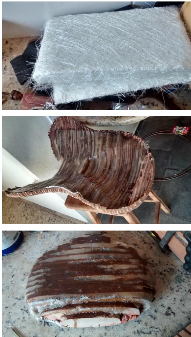
Figura 44 Exemplo de manta de fibra de vidro e fibra de vidro laminada com poliéster para reforço estrutural das peças.
