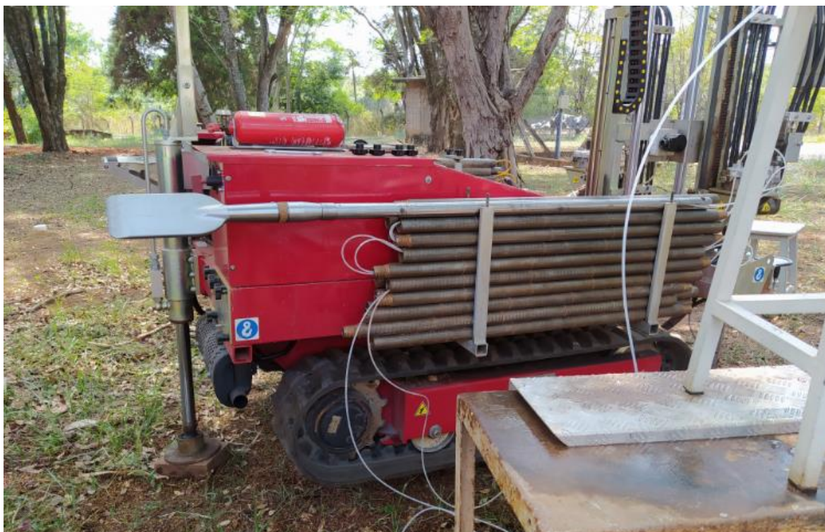
Figura 47: Detalhe do dispositivo de inundação acoplado a lâmina do DMT.
