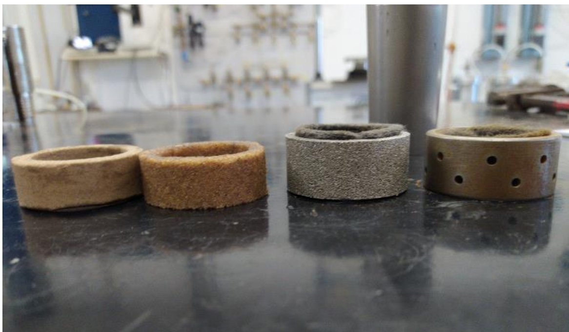
Figura 39: Anéis de proteção da saída de água do dispositivo, da esquerda para direita: pedra porosa com areia retida na peneira #50, pedra porosa com areia retida na peneira #40, anel em aço poroso e anel vazado.
