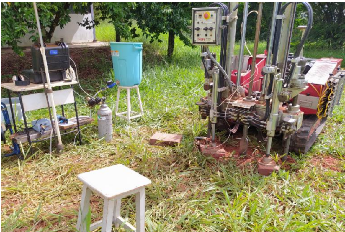
Figura 48: DMT com inundação pronto para ser iniciado.
