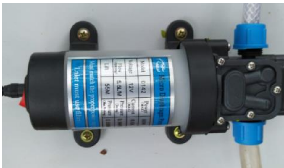
Figura 45: Bomba de 12 V e 80 W utilizada para alimentar com água o dispositivo durante o processo de inundação no campo.
