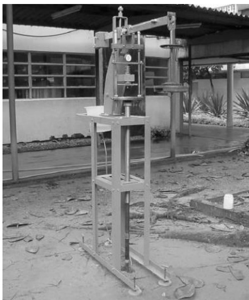
Figura 15: Segunda versão do Expansocolapsômetro. Fonte: Ferreira et al (2002).
