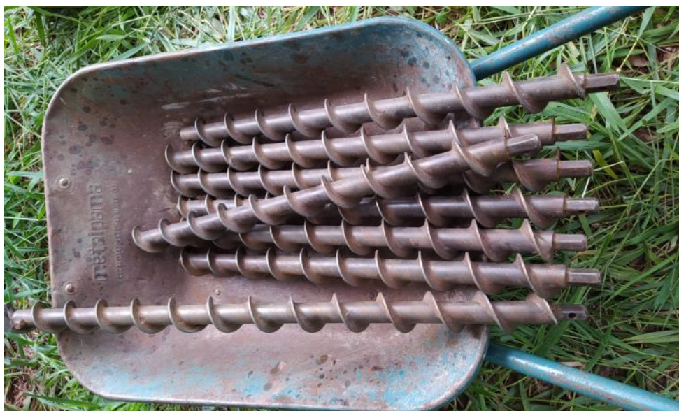
Figura 36: Trados helicoidais de 63,5 mm de diâmetro e de 0,75 m de comprimento para amostragem do solo.
