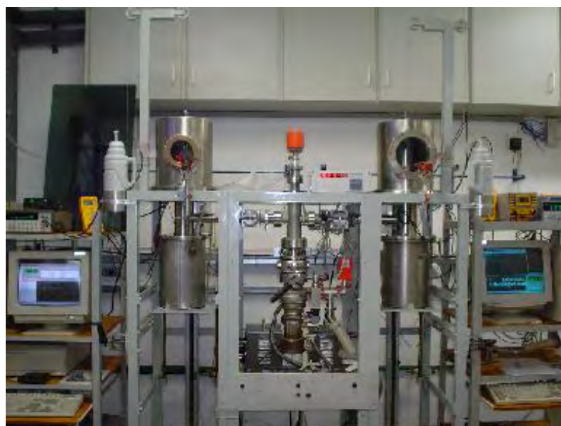
Figura 14 – Fotografia do Pêndulo de Torção do Laboratório de Anelasticidade e Biomateriais.
