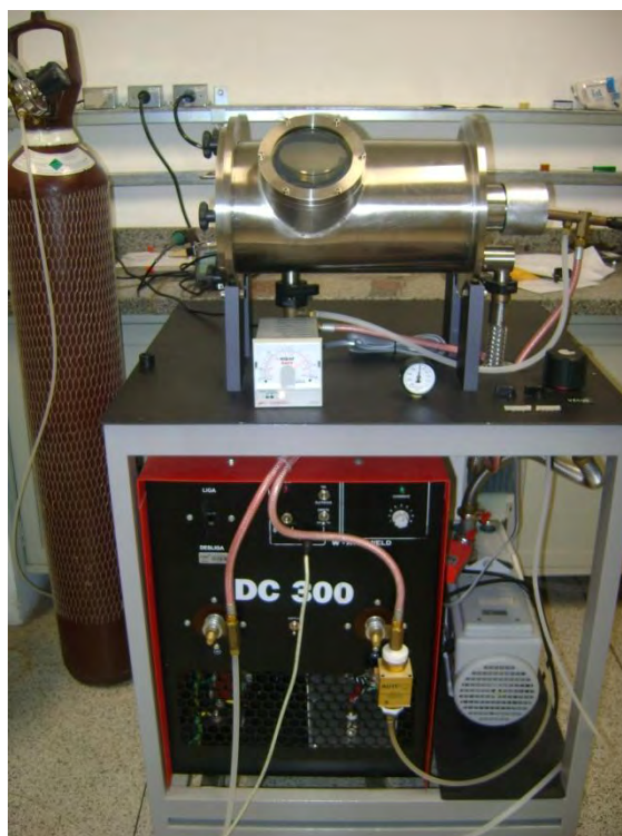
Figura 7 – Forno de fusão a arco-voltaico, usado na preparação das amostras.
