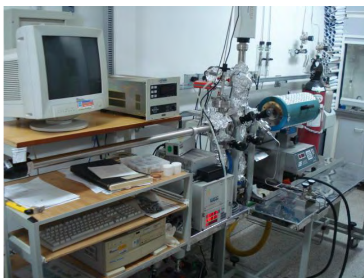
Figura 9 – Fotografia do sistema de tratamento térmico e dopagem das amostras utilizadas neste trabalho.
