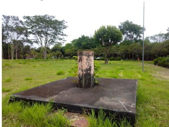
Figura 8 - Marco geodésico EP01 com coordenadas conhecidas.
