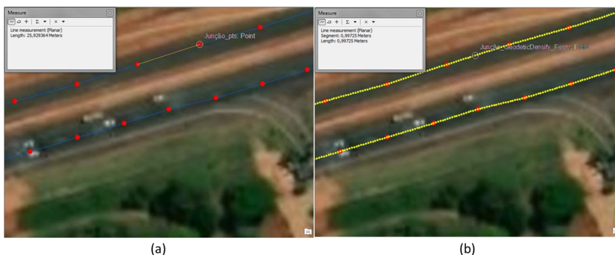
Figura 29 - Etapa de densificação das trajetórias GNSS: (a) Exemplo de trajetória antes da densificação; e (b) Trajetória após a densificação, com os pontos interpolados em amarelo.
